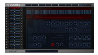
Cette page permet de créer vos propres modèles de commande à distance lorsque vous souhaitez utiliser le Virus TI comme surface de commande pour d'autres appareils MIDI. Les 32 modèles de contrôle à distance disponibles dans le Virus TI sont affichés dans le champ supérieur. Vous pouvez les charger (pour les éditer) en double-cliquant dessus.
