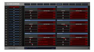
Comprend les six slots de la matrice de modulation. Les champs sans intitulé situés au-dessus des trois Destinations dans chaque slot servent à sélectionner les sources.
