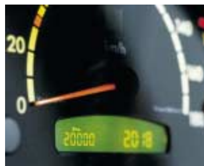
ASSYST : indicateur dynamique de maintenance pour des intervalles de vidange de 40 000 km maxi., en fonction des sollicitations réelles
