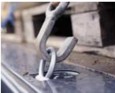
Œillets de fixation dans le plancher du plateau
