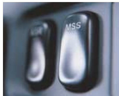
Système Start/Stop : après 3 secondes d'arrêt (à un feu par ex.), le moteur est automatiquement coupé pour économiser du carburant
