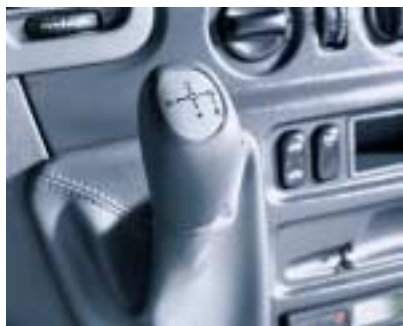
La boîte automatisée SPRINTSHIFT (en liaison avec les moteurs CDI) propose une commande entièrement automatique ou par impulsions
