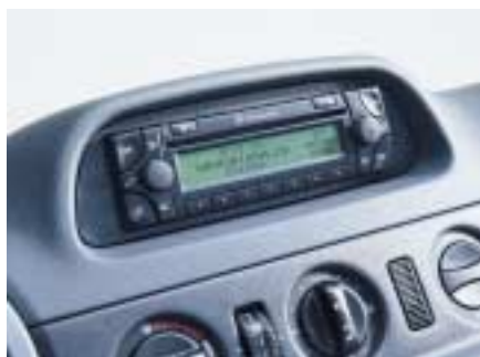
Nouvelle génération d'autoradios avec lecteur de cassettes ou de CD. Système de communication embarqué « Sound 40 Pro » constitué d'une plate-forme télématique avec module de navigation, téléphone intégré et accès Internet WAP
