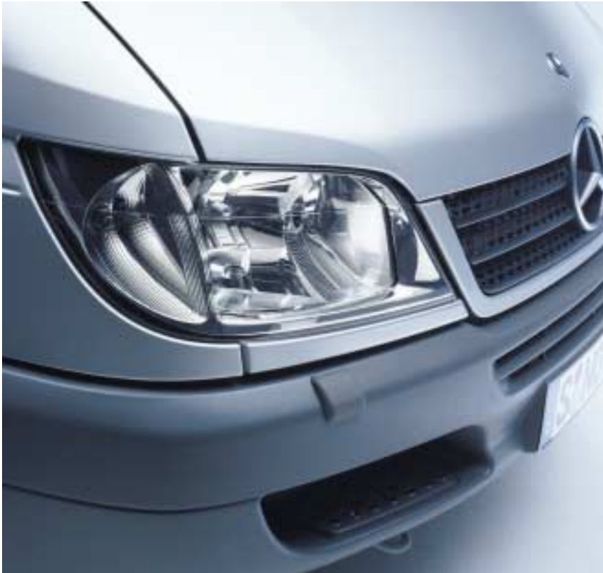
Blocs optiques avec diffuseurs en verre transparent, réglage de la portée des projecteurs et clignotants blancs
