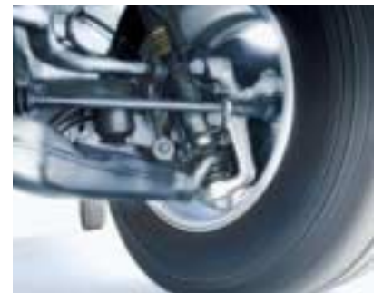
Suspension indépendante des roues avant
