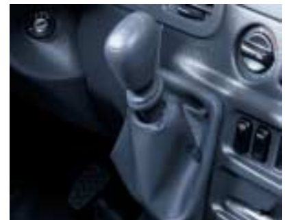
Levier de vitesses de type joystick intégré à la planche de bord
