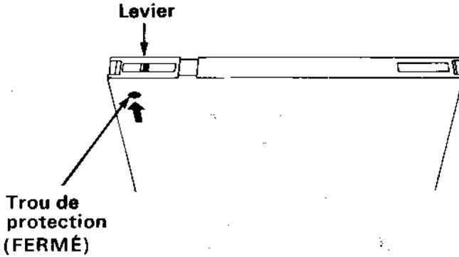
Pour ouvrir le trou de protection sur ce genre de disquette, il faut faire glisser le levier vers le milieu de la disquette en utilisant la pointe d'un stylo, par exemple.
