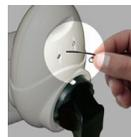
1.Appuyer et maintenir le trombone dans l'orifice situé entre les deux LEDs jusqu'à ce que la LED s'allume en vert.(environ après 3 à 4 secondes)
