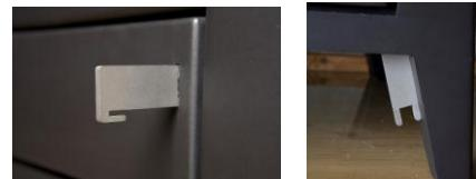
**Aduro-nyckel:** Den här nyckeln medföljer kaminen och används för att sköta sekundärspjället. Nyckeln sätts fast på "handtaget" så att du kan justera lufttillförseln från sida till sida. Dra spjället åt höger för att öka lufttillförseln och åt vänster för att minska den. När nyckeln inte används kan du hänga den på kaminens ben. Nyckeln används även för att öppna panelen under luckan.
