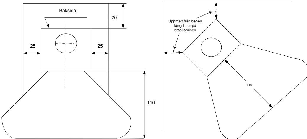
**Obs!** Det är viktigt att braskaminen installeras på ett golv med tillräcklig bärighet. Om den befintliga konstruktionen inte uppfyller de här kraven måste golvet förstärkas på lämpligt sätt (t.ex. med hjälp av en platta som fördelar belastningen över en större yta) för att uppnå detta.
