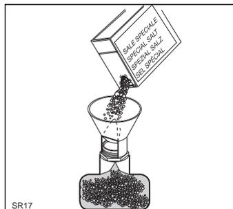
4. A l'aide de l'entonnoir livré avec l'appareil, remplissez le réservoir de sel.
