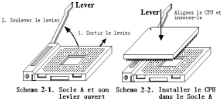
L'installation des processeurs AMD Socket A Athlon™ XP, Athlon™ et Duron™ est très facile, autant que celle des CPUs Socket 7 Pentium® avant. Parce qu'ils utilisent le "Socket A" ZIF (Zero Insertion Force), il est très aisé de fixer fermement votre processeur dans sa position. La Figure 2-1 vous montre à quoi ressemble un Socket A et comment utiliser le levier. Le nombre de pins du Socket A est plus important que celui du Socket 7. De ce fait, un CPU Pentium ne peut être inséré dans un Socket A.
