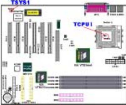
Le TCPUI sert à détecter la température de l'UC. Le TSYS1 sert à détecter la température de l'environnement système. Vous pouvez consulter les valeurs mesurées dans le BIOS ou sur l'écran principal de l'application de suivi des éléments matériels.
