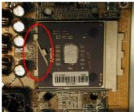
Veillez suivre la séquence décrite ici, veuillez **Ne Pas** inverser cette séquence. Autrement, vous pourriez être confronté à une situation comme sur la photo de gauche. Du fait de la conception des sockets CPU, les crochets du côté gauche ne sont pas aussi solides que ceux du côté droit. Si vous suivez nos suggestions, tout se passera correctement.
