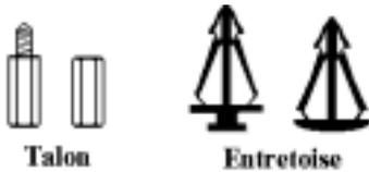
**Figure 2-3. Schéma d'un talon et d'une entretoise**
