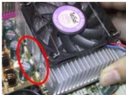
Insérez le levier de fixation côté gauche du dissipateur sur le crochet du socket côté gauche. Assurez-vous que la prise soit bien ferme et étroite. Vérifiez sur la photo à gauche.
