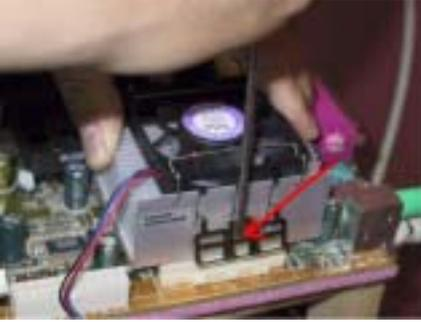
Insérez un tournevis plat sur le milieu du levier de fixation côté droit et pousser doucement vers le bas. Poussez vers le bas et par-dessus les crochets du socket côté droit. Vérifiez sur la photo à gauche.
