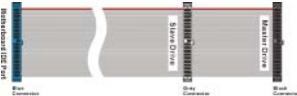
**Illustration 2-10. Schéma d'une nappe de connexion Ultra DMA 66**
