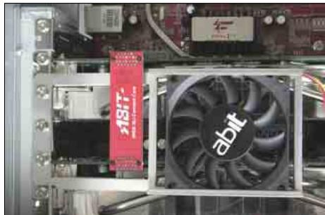
4. Pour installer avec l'équerre de fixation SLI, dévissez le trou central du panneau E/S, insérez l'équerre de fixation SLI puis fixez.
