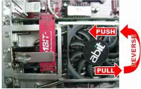
5. Pour installer sans l'assemblage du Ventilateur SLI, connectez la "Carte du Connecteur SLI" juste après avoir installé les deux cartes graphiques puis insérez et fixez l'équerre de fixation SLI.
