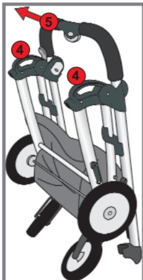
Теперь сожмите боковые ручки корпуса и потяните верхнюю ручку вверх (цифра 5), пока она со щелчком не зафиксируется.
