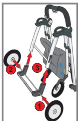
Helyezze fel a két hátsó kereket a hátsó tengelyre, amíg az hallhatóan be nem kattan (1. & 2. sz.).
