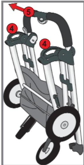
Pidä seuraavaksi ratasosan kahvoista kiinni (nuoli 4), ja vedä työntöaisaa ylöspäin (nuoli 5), kunnes se kiinnitptyy tukevasti napsahtamalla.
