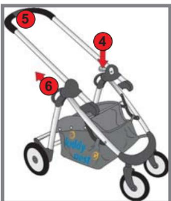
Turvavipu kiinnitettynä napsahtamalla, ja estää sen, että sormet pääsevät puristumaan väliin.
