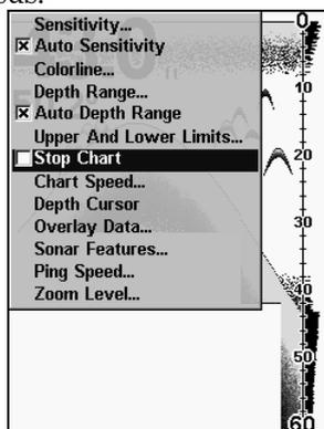
Menu du Sondeur avec la commande d'Arrêt du Défilement de l'Image sélectionnée. La case n'est pas cochée, ce qui signifie que le graphique défile à l'écran.
