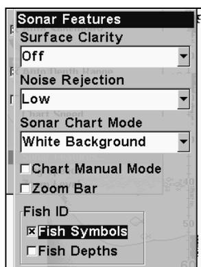
**Menu des Fonctions du Sondeur avec les Symboles Fish I.D. sélectionnés. Lorsque la petite case à gauche est cochée, cela signifie que la fonction est activée.**
