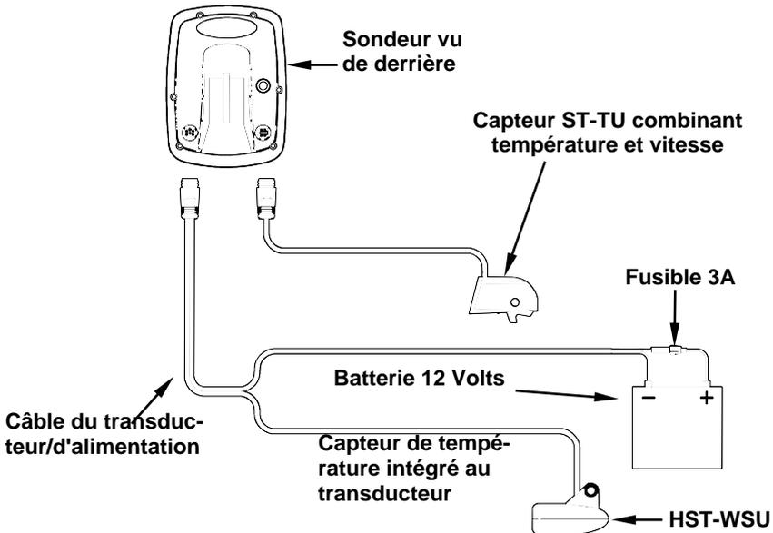
Sondeur avec capteur extérieur de température et de vitesse combinées. Un premier capteur de température est intégré au transducteur.
