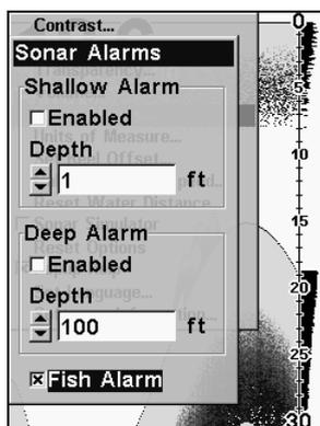
Menu des Alarmes du Sondeur avec l'Alarme de Poisson sélectionnée.
