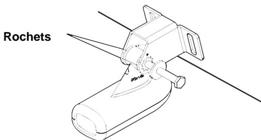
**Insérez le boulon et vérifiez la position du transducteur sur le tableau.**
