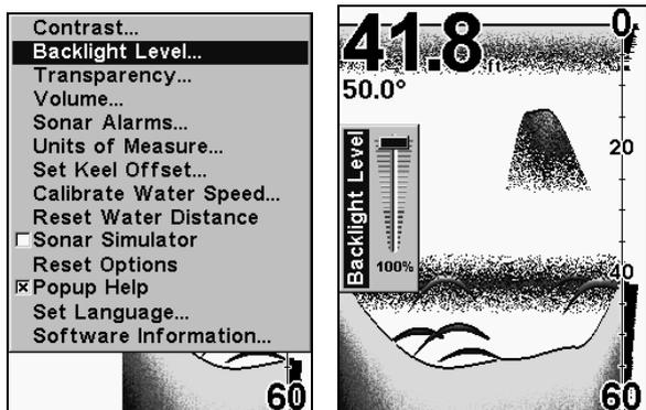
Commande d'Intensité du Rétro-éclairage, à gauche, et barre de contrôle de la luminosité, à droite. La barre de contrôle apparaît automatiquement lorsque vous allumez l'appareil.
