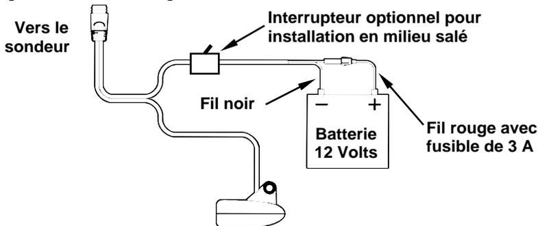
**Branchement du sonar FishEasy 320c (ici, branchement direct à la batterie).**
