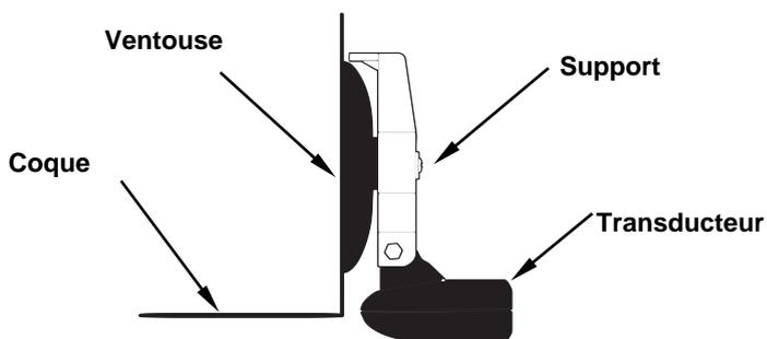
**Transducteur portable installé sur le tableau arrière du bateau.**
