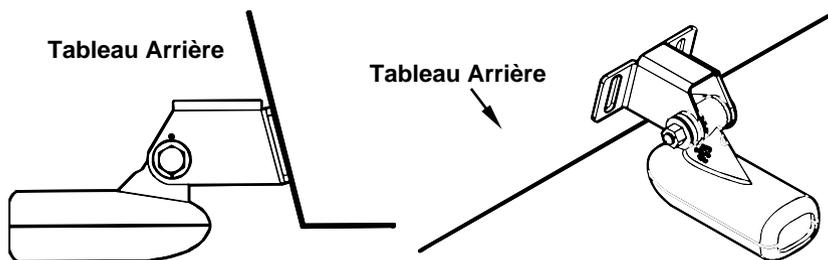
Positionnez le transducteur sur le tableau et marquez l'emplacement des trous. Vue de côté à gauche et vue du dessus à droite.
