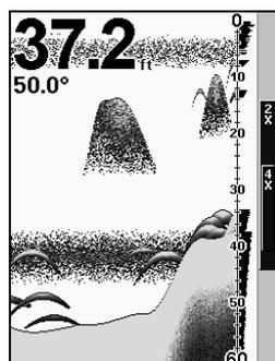
Dans l'illustration de gauche, la Clarté de Surface est désactivée. L'illustration de droite montre la Clarté de Surface fixée au niveau Haut.
