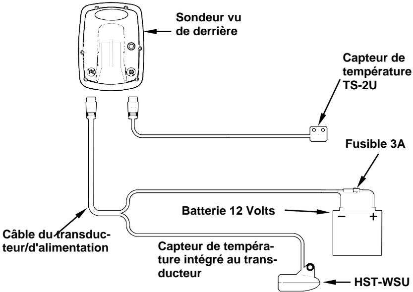
Sondeur avec second capteur externe de température. Un premier capteur de température est intégré au transducteur.
