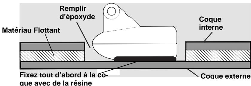
**Fixez le transducteur à la coque avec de la résine époxyde au niveau d'une portion compacte.**
