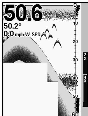
**Graphique du Sondeur avec les Données de Superposition activées. Cet exemple montre la Profondeur, la Température de l'Eau et la Vitesse en Surface du bateau.**
