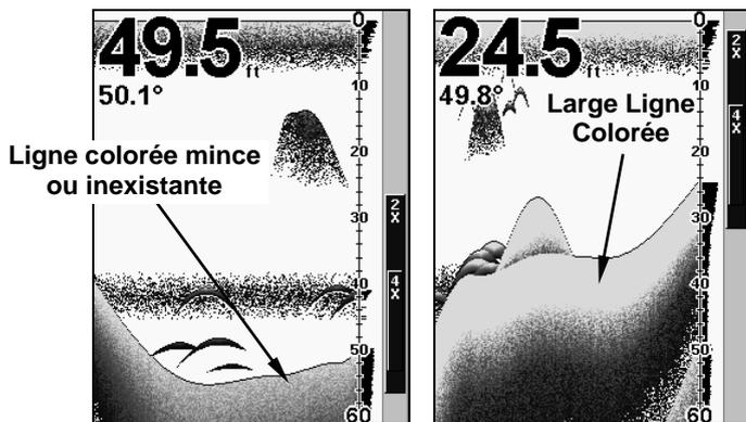
A gauche, une étroite ligne de couleur indique la présence d'un fond mou, probablement constitué de boue ou de sable. A droite, une ligne de couleur plus large indique la présence d'un fond dur, rocheux.
