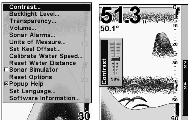
Commande du Contraste, à gauche, et barre de contrôle du Contraste, à droite.
