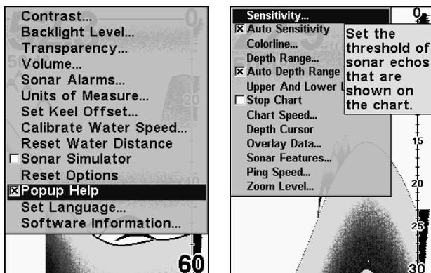
Menu Principal, à gauche, avec la commande des Info-Bulles sélectionnée. A droite, cet exemple montre le message d'Aide pour la commande de la Sensibilité, se trouvant dans le menu du Sondeur.
