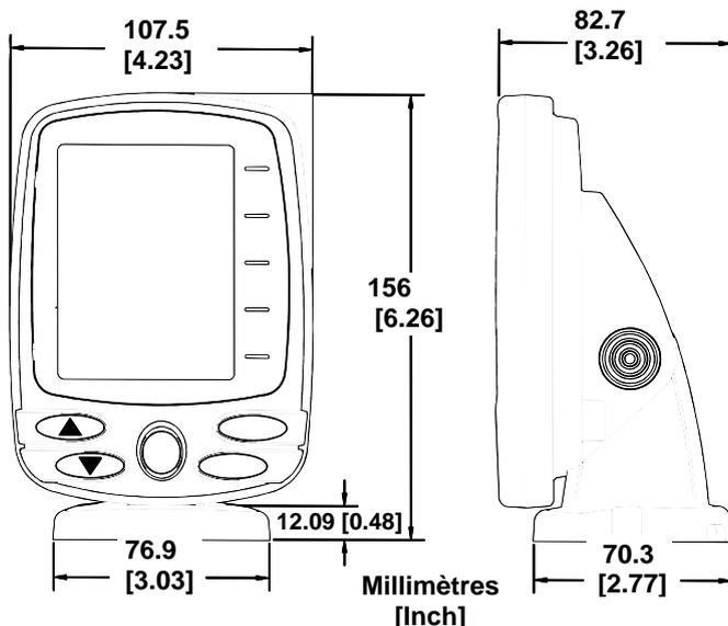
Vues de face (à gauche) et de côté (à droite) illustrant les dimensions du
