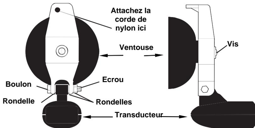
**Assemblage du transducteur portatif : vue arrière (à gauche) et vue de côté (à droite.)**
