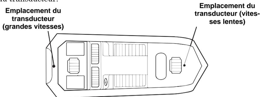
**Positions d'installation du transducteur dans la coque pour un fonctionnement à grande ou à faible vitesse.**
