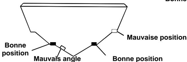
Les bonnes et les mauvaises positions pour l'installation du transducteur.
