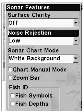
Dans le Menu des Fonctions du Sondeur, le Rejet du Bruit est sélectionné avec l'ASP réglé par défaut au niveau le plus bas (low).
