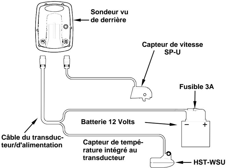
Sondeur avec capteur de vitesse. Le capteur de température est intégré au transducteur.
