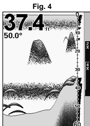
Ces figures montrent l'affichage d'une même zone avec des sensibilités différentes. Fig.1 : Sensibilité à 87%, Sensibilité Automatique typique du mode automatique. Fig.2 : Sensibilité réglée à 50%. Fig. 3 : Sensibilité réglée à 20%. Fig.4 : Sensibilité réglée à 100%.
