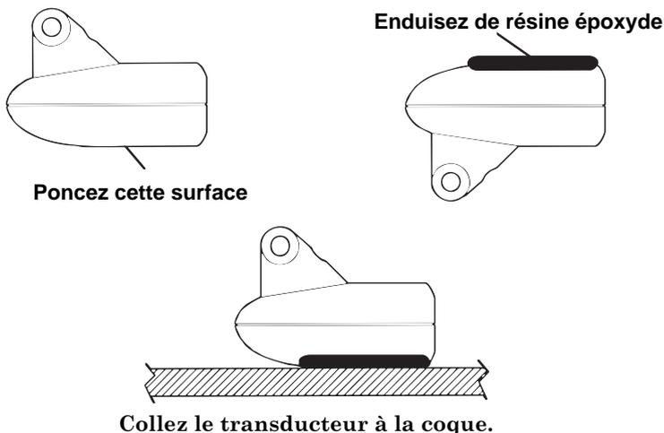
Enfoncez le transducteur dans l'époxyde, en le tournant de façon à chasser toutes bulles d'air de sous sa surface. Le transducteur doit être parallèle à la coque, avec une quantité minimale de résine entre le transducteur et la coque. Une fois que l'époxyde est sèche, pensez à remplir la zone autour du transducteur avec davantage de résine et acheminez le câble jusqu'au sondeur.
