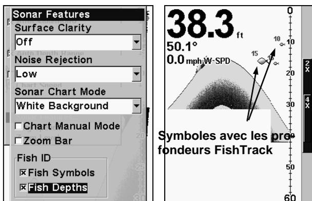
A gauche, menu des Fonctions du Sondeur avec la Profondeur Fish I.D. sélectionnée. Lorsque la petite case à gauche est cochée, cela signifie que la fonction est activée. A droite, Affichage du Sondeur montrant les symboles Fish I.D. avec les profondeurs FishTrack.
