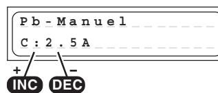
Avec ce programme, le courant de charge maximal admissible pour l'acca à charger sera réglé avec les touches INC/DEC, avant sa connexion sur le chargeur. Ce réglage place seulement la limite supérieure, car le chargeur doit sonder l'acca.
