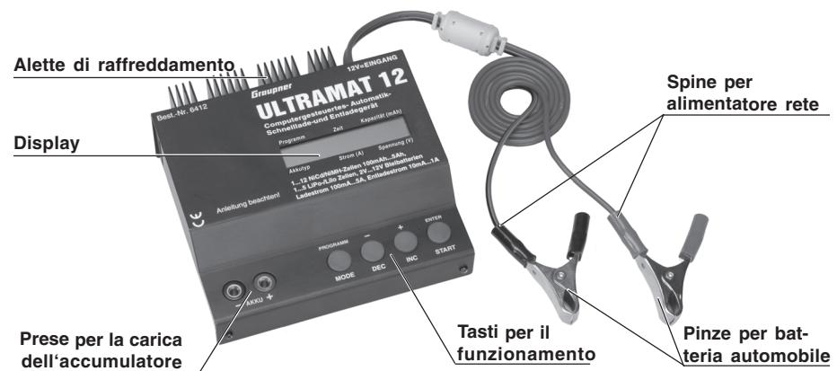
Il funzionamento del caricabatterie si effettua con solo quattro tasti di servizio. Oltre ai tasti –DEC e +INC, con i quali vengono variati i valori della corrente e della tensione, ci sono i tasti di servizio che, se un accumulatore è o non è collegato, svolgono ciascuno funzioni diverse:
