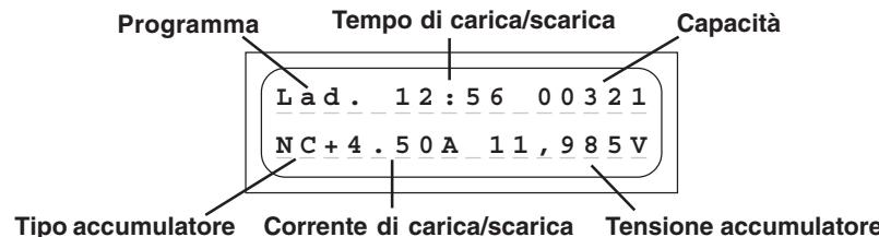
I dati essenziali relativi alla carica e scarica vengono visualizzati chiaramente sulle due righe del display a cristalli liquidi e sono mantenuti fino allo scollegamento dell'accumulatore. Quando viene collegato un altro accumulatore i valori precedenti non sono più richiamabili.
