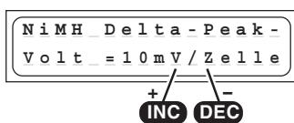
La tensione di riferimento (in mV per cella!) dello spegnimento automatico per gli accumulatori NiMH può essere impostata. Gli accumulatori NiMH tuttavia hanno una caduta di tensione inferiore agli accumulatori NiCd. Si sono rivelati accettabili valori di impostazione della tensione di 5 ... 25 mV/cella. Tensioni superiori provocano rapidamente una sovraccarica dell'accumulatore, tensioni inferiori provocano spesso un'interruzione anticipata.
