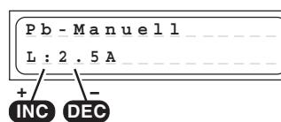
Con questo programma si può impostare, prima di collegare l'accumulatore, con i tasti INC / DEC, la massima corrente di carica ammessa (corrente di carica massima).
