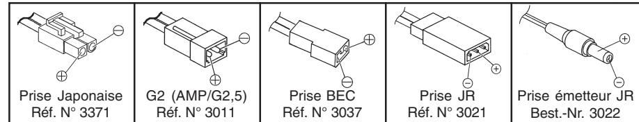
Utiliser uniquement des cordons de charge originaux avec des fils d'une section suffisante. Noter que chaque cordon de charge devra préalablement être raccourci sur une **longueur maximum de 30 cm**.
