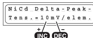
La coupure de charge automatique (Détection pleine charge de l'accu) travaille selon le procédé Delta-Peak des millions de fois éprouvé (appelé aussi Delta-U ou Delta-V). Ces procédés valorisent la tension maximum de la courbe de charge, laquelle calcule exactement l'atteinte de la charge maximale.
