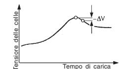
Lo spegnimento automatico del processo di carica (riconoscimento di accumulatore completamente carico) funziona secondo il principio del delta peak, già provato milioni di volte e noto anche come delta-U o delta-V. In questo procedimento viene valutata la tensione massima della curva di carica, che indica con molta precisione la massima carica immagazzinata.
