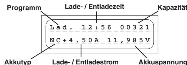
Die während der Ladung /Entladung wichtigen Daten werden übersichtlich auf der zweizeiligen Flüssigkristallanzeige wiedergegeben und sind bis zum Abklemmen des zu ladenden Akkus sichtbar. Wird ein weiterer Akku geladen sind die vorher angezeigten Werte nicht mehr abrufbar.
