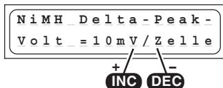
Die Ansprechspannung (in mV pro Zelle!) der Abschaltautomatik für NiMH-Akkus kann eingestellt werden. NiMH-Akkus haben gegenüber NiCd-Akkus einen weniger ausgeprägten Spannungsrückgang. Als praktikabel haben sich Spannungseinstellungen von 5 ... 25mV/Zelle herausgestellt. Höhere Spannungen führen häufig zur Überladung der Batterie, niedrigere Spannungen führen oft zu Frühabschaltung. Den für Ihren Akku günstigste Wert sollten Sie durch Probelaufungen ermitteln.
