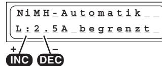
In questo programma il caricabatterie riconosce il tipo di accumulatore collegato e adegua la corrente di carica adatta, in modo da evitare una sovraccarica all'accumulatore.
