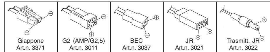
Usate solamente cavi di ricarica originali con sufficiente sezione.
