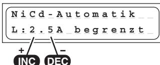
In questo programma il caricabatterie riconosce il tipo di accumulatore collegato e adegua la corrente di carica corretta, in modo da evitare un sovraccarico dell'accumulatore. La corrente di carica massima può essere impostata con i tasti INC / DEC prima di collegare l'accumulatore da 0.1 a 7.0 A senza limitazioni. Il processo di carica termina in accordo con i valori impostati per la tensione di spegnimento del delta peak.
