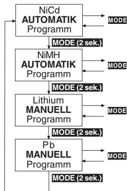
Die Lade- und Einstellungsmöglichkeiten des ULTRAMAT 12 sind übersichtlich und logisch in vier Programmgruppen unterteilt. Für die unterschiedlichen Akkutypen: NickelCadmium-, Nickel-Metal-Hydrid-, LithiumIonen/LithiumPolymer und Pb (Blei)-Akkus steht jeweils eine eigene Programmgruppe zur Verfügung.
