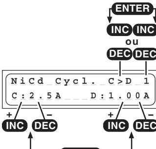
Ce programme sert pour l'optimisation de la capacité et le cyclage d'une batterie.
