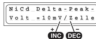
Die Ladeabschaltautomatik (Akku-Vollerkennung) arbeitet nach dem millionenfach bewährten Delta-Peak-Verfahren (auch bekannt als Delta-U- oder Delta-V-Verfahren). Dieses Verfahren wertet das Spannungsmaximum der Ladekurve aus, welches recht genau das Erreichen des maximalen Ladungsinhaltes angibt.
