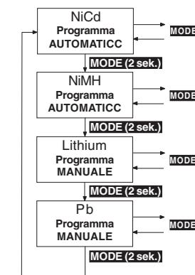
Le possibilità di carica e scarica dell'ULTRAMAT 12 sono suddivise in modo chiaro e logico in quattro gruppi di programmi. Per i diversi tipi di accumulatori : Nichel-Cadmio, Nichel-Metal Idrato, Ioni di litio / Polimeri di litio e Piombo c'è a disposizione un proprio gruppo di programmi
