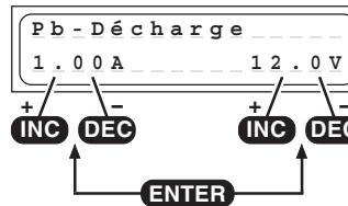
Ce programme sert par ex. pour déterminer la capacité restante d'un accu de propulsion.
