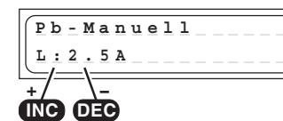
Bei diesem Programm wird **vor** dem Anstecken des zu ladenden Akkus mit den INC / DEC-Tasten der für den Akku maximal zulässige Ladestrom (maximal Ladestrom) eingestellt.
