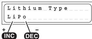
C'est le programme de réglage le plus important pour les accus au Lithium. Le type d'acca sera déterminé dans cette sélection. Celui-ci sera soigneusement réglé et vérifié, car le chargeur travaille sur tous les autres paramètres de charge pour ces réglages. Le réglage des types d'accus (LiPo ou Lilo) influence la tension de coupure. Si un accu au Lithium n'est rechargeé qu'au 2/3 de sa capacité, c'est qu'un mauvais type d'acca a été réglé.
