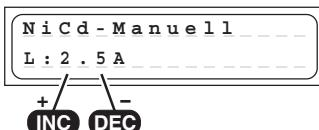
Con questo programma potete caricare il vostro accumulatore con la corrente impostata. La corrente massima può essere impostata prima di collegare l'accumulatore con i tasti INC / DEC da 0.1 a 7.0 A.
