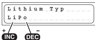
Questo è il più importante programma di impostazione per i pacchi batteria al litio. In questo programma viene impostato il tipo di accumulatore. Questa impostazione va fatta con molta attenzione e verificata, poiché da essa il caricabatterie ricava tutti gli altri parametri per la carica.
