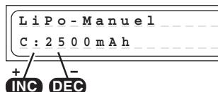
Avec ce programme, l'accu sera chargé avec la Capacité-Courant de L : 2,5 0 0 charge réglé.
