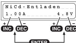
Questo programma serve per es. per determinare la capacità residua o per scaricare ad un determinato livello l'accumulatore di una trasmittente, di una ricevente o di alimentazione di un motore.
