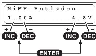
Questo programma è utile per es. per determinare la capacità residua oppure per la scarica dell'accumulatore di una trasmittente, di una ricevente o di alimentazione di un motore. Con questo programma viene effettuata la scarica con una corrente di scarica impostata (0.10 ... 1.0 A, a sinistra sul display) fino alla tensione finale di scarica (0.5 ... 16.8 V o automatica, a destra sul display).
