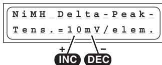
La tension d'intervention (en mV par élément) de la coupure automatique pour les accus NiMH pourra être réglée. Les accus NiMH ont une perte de tension plus faible par comparaison aux accus NiCd. Le réglage d'une tension de 5...25 mV/élément s'est révélé être le mieux adapté. Une tension plus élevée conduit le plus souvent à une surcharge de la batterie et une tension plus faible à une coupure prématûrée. La valeur la mieux adaptée pour l'accu à charger sera déterminée par des essais de charge.
