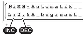
In diesem Programm erkennt das Ladegerät den angeschlossenen Ni-Mh Akkutypen und passt den Ladestrom dementsprechend an, sodass eine Überlastung des Akkupacks verhindert wird.
