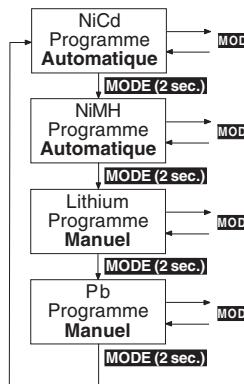
Les possibilités de charge et de décharge de l'ULTRAMAT 12 sont clairement et logiquement réparties dans les quatre groupes de programmes. Un groupe de programmes propre à chacun des différents types d'accu NiCd, NiMH, LiPo/LiPo et Pb (Plomb) est à disposition. Un autre groupe de programmes permet des possibilités de réglage Programme individuelles du chargeur.
