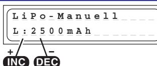
Con questo programma l'accumulatore viene caricato con una corrente di carica relativa alla capacità impostata. Prima di collegare l'accumulatore da caricare, impostate la capacità dell'accumulatore (e quindi la corrente massima) con i tasti INC / DEC (50 ... 7000 mAh). Il caricabatterie calcola automaticamente la corrente di carica 1 C.
