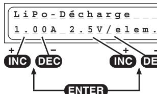
Ce programme sert par ex. pour déterminer la capacité restante d'un accu au Lithium non entièrement vide.
