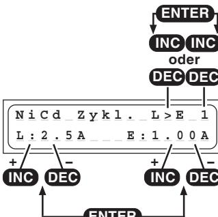
Questo programma serve per ottimizzare la capacità e la formattazione di un accumulatore. In alto a destra sul display impostate, con i tasti INC / DEC se il programma di formattazione deve iniziare con la carica o la scarica. Quindi impostate il numero di cicli da 1 a 5 (per es. impostando 3 cicli, l'accumulatore viene caricato e scaricato tre volte).
