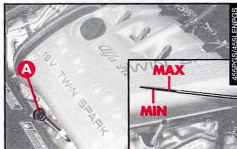
fig. 8 - moteur 2.0 T.SPARK
