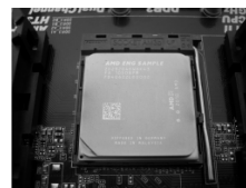
步驟4： 下推並鎖住插座拉桿
