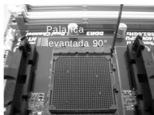
PASO 1: Levante la Palanca del Zócalo
