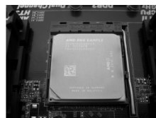
ШАГ 4. Прижмите и зафиксируйте рычаг гнезда.
