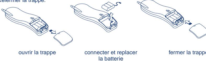
**! Utiliser uniquement des batteries rechargeables de caractéristiques identiques à celles fournies avec le produit. En cas de non respect de cette recommandation, la responsabilité du constructeur ne pourra être engagée.**
