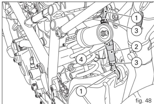
La cote maximale de dégagement de l'UNIBALL de la tête (A) d'articulation est de 5 filets, ce qui correspond à 7,5 mm (B).
