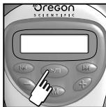
Pour mettre en marche, appuyer sur ►/■ sans relâcher pendant 2 secondes. L'appareil se met sur STOP et affiche l'icône ■ .
