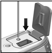
Pour réinitialiser l'appareil: Lorsqu'il est en marche, appuyer sans relâcher sur **RESET** (à l'aide d'une bille de stylo ou d'une mine de crayon) jusqu'à ce qu'il s'éteigne. Puis, le remettre en marche pour reprendre le fonctionnement normalement.
