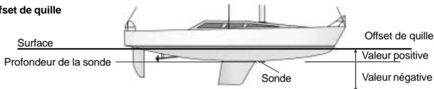
**NB :** le bateau représenté est équipé d'une sonde traversante
