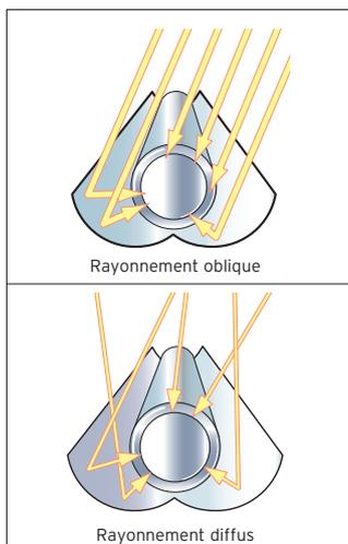
Un concentrateur parabolique externe est situé sous les tubes. Il dirige vers les tubes, par réflexion, le rayonnement qui passe entre les tubes de telle sorte que la surface d'absorption du capteur est optimisée. Il permet aussi de mieux capter le rayonnement solaire lorsqu'il est oblique (par rapport au capteur) et lorsqu'il est diffus (par temps couvert). Cette technologie est donc efficace pour pallier les petits problèmes d'orientation et
