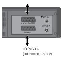
Pour copier une cassette d'un autre magnétoscope, raccordez celui-ci à la prise EURO AV 1/2 ou à la prise de face de votre magnétoscope et sélectionnez « AV 1/2 » en pressant la touche AV.
