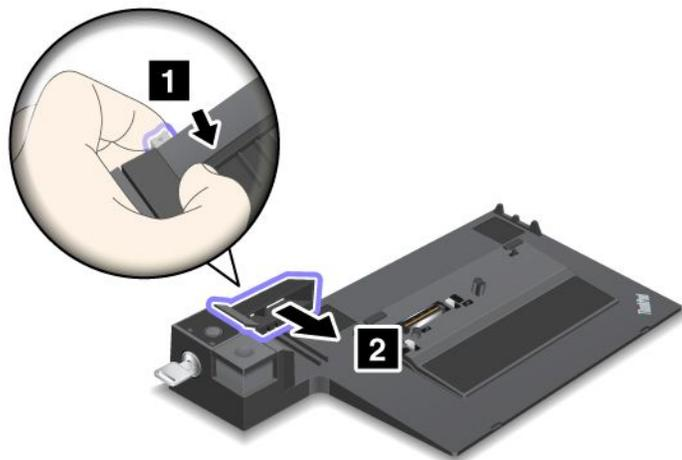
3. Installez l'ordinateur sur la plateforme de la station d'accueil, en vérifiant l'alignement entre l'angle supérieur gauche de l'ordinateur et la plaque de guidage de la station d'accueil.
