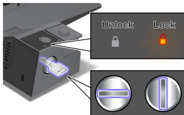
Lorsque la clé se trouve en position verrouillée, le bouton d'éjection de la station d'accueil est verrouillé et vous ne pouvez pas retirer votre ordinateur. Le voyant de verrouillage est allumé lorsque le bouton d'éjection est verrouillé.
