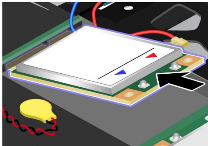
10. Faites pivoter la carte jusqu'à ce qu'elle s'enclenche en appuyant sur la partie supérieure des connecteurs et fixez-la à l'aide de la vis.
