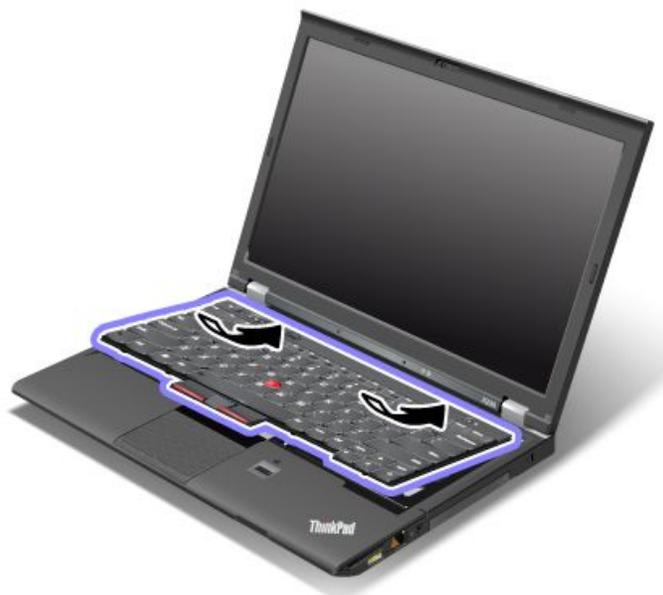
3. Appuyez légèrement sur le clavier, puis faites-le glisser dans le sens indiqué par les flèches. Assurez-vous que les bords du clavier se trouvent sous le cadre.
