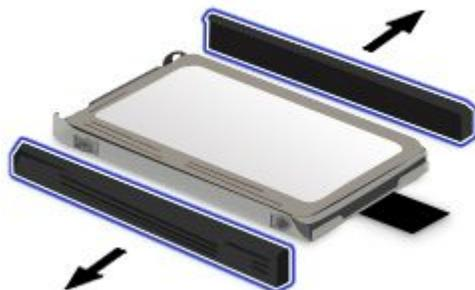
7. Remettez les protections latérales en caoutchouc sur la nouvelle unité de disque dur ou les glissières latérales sur la nouvelle unité SSD.
