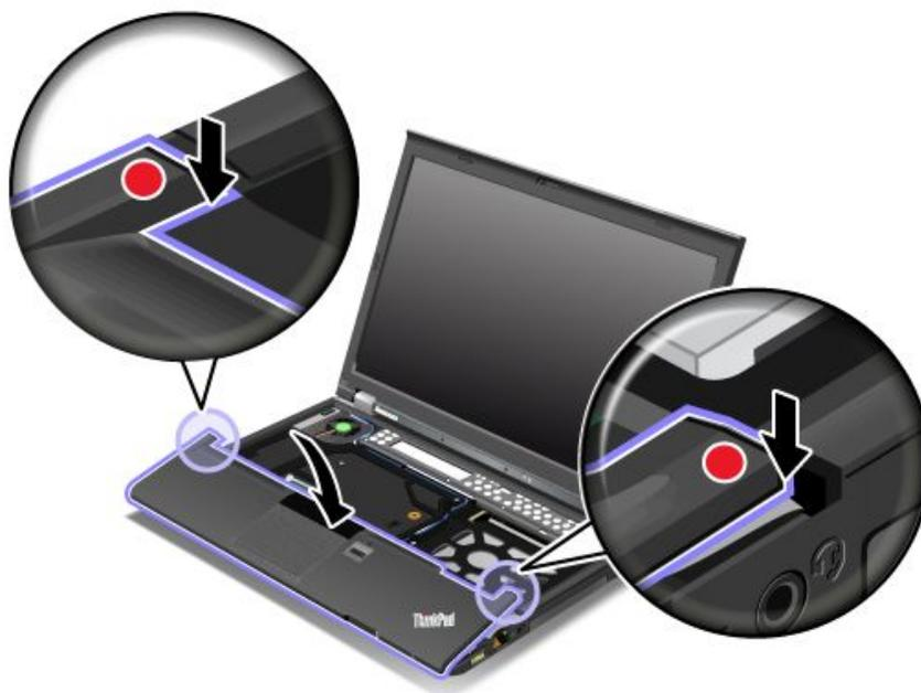
2. Appuyez sur le bord du repose-mains jusqu'à ce qu'il se mette en place.
