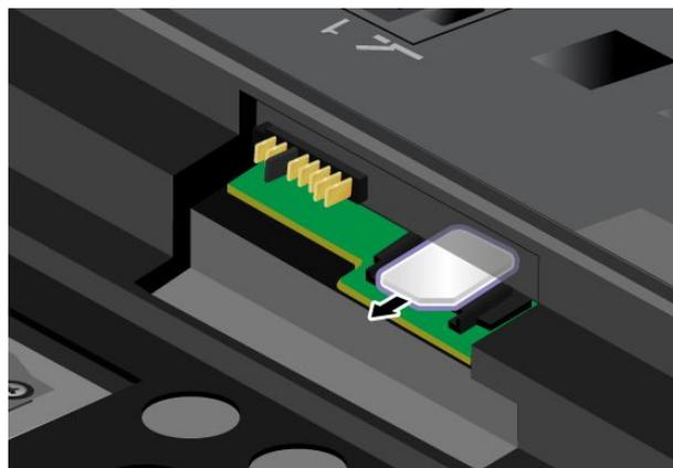
5. Insérez fermement la nouvelle carte SIM dans le logement.
