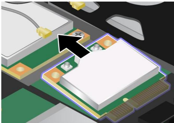
9. Aligned le bord de contact de la nouvelle carte réseau étendu sans fil sur le contact femelle correspondant.
