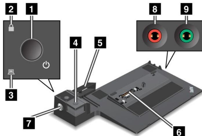
**1 Interrupteur d'alimentation** : appuyez sur l'interrupteur d'alimentation pour mettre l'ordinateur sous tension ou hors tension.
