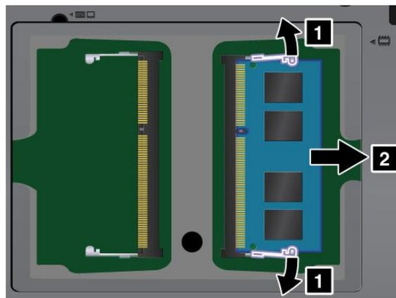
5. Repérez l'encoche sur le côté du bord de contact du module de mémoire que vous installez.
