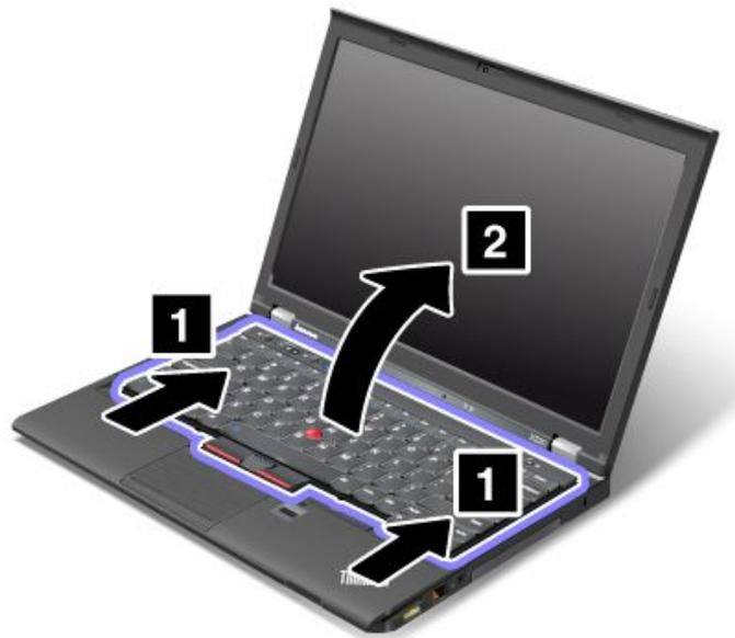
7. Soulevez doucement le clavier jusqu'à voir son point de connexion. Maintenez le clavier au-dessus de l'ordinateur **1**, puis détachez le connecteur **2**. Retirez le clavier.
