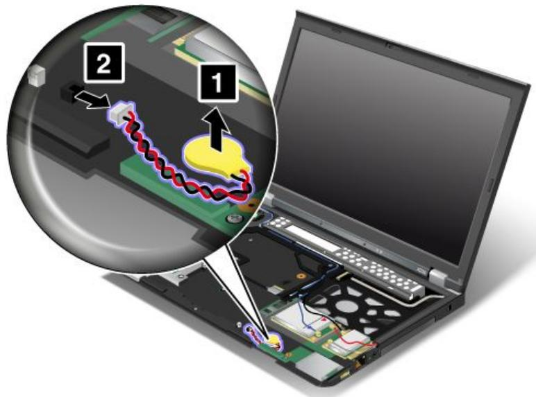
7. Installez la nouvelle batterie de secours et branchez le câble.
