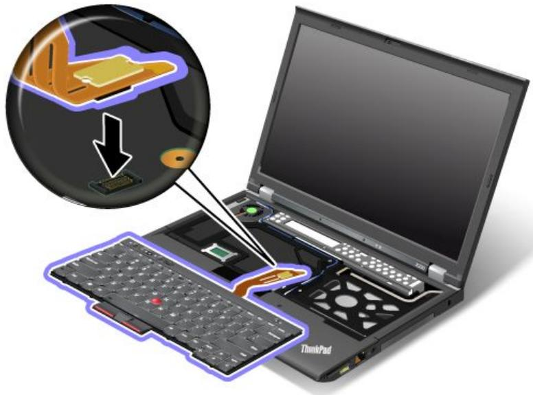
2. Insérez le clavier. Assurez-vous que les bords du clavier, à l'arrière, se trouvent sous le cadre.
