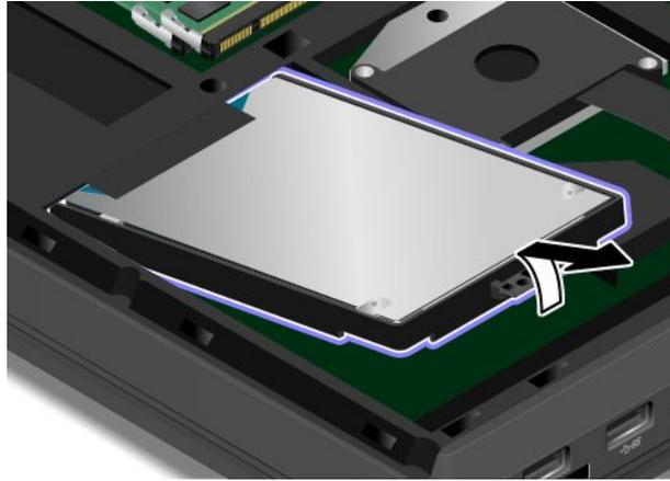
6. Retirez le système de retenue de l'unité de disque dur ou de l'unité SSD. Fixez ensuite le système de retenue sur la nouvelle unité de disque dur ou unité SSD.
