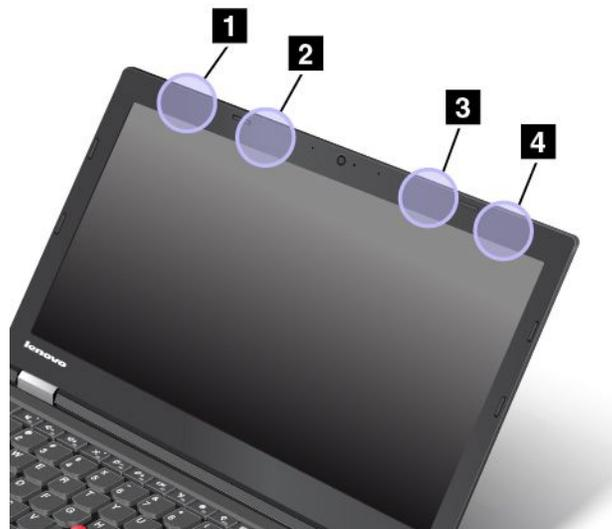
**1** Antenne réseau local sans fil (auxiliaire)
