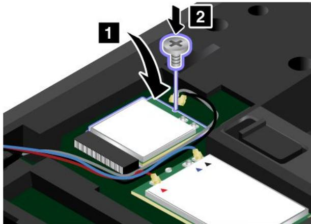
9. Branchez les câbles de l'antenne sur la nouvelle carte réseau local sans fil. Branchez le câble gris sur le connecteur principal sur la carte et le câble noir sur le connecteur auxiliaire sur la carte.
