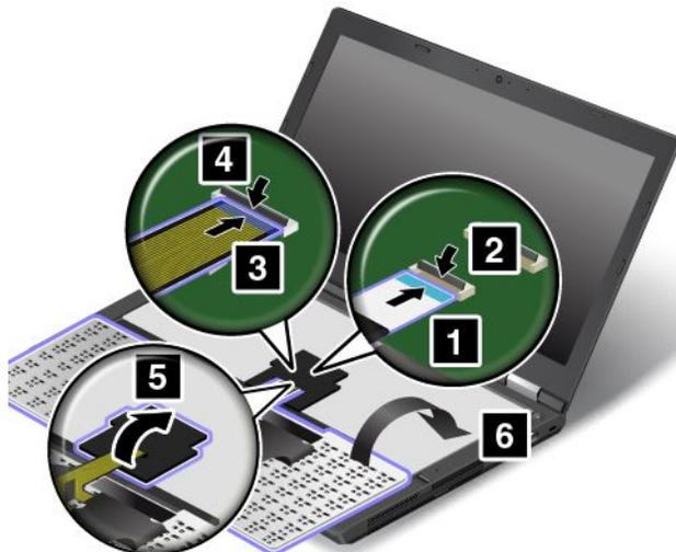
2. Insérez le clavier dans le panneau du clavier comme indiqué. Assurez-vous que les bords du clavier, à l'avant, se trouvent sous le cadre du panneau du clavier.
