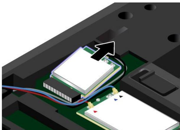
7. Aligned l'encoche de la nouvelle carte réseau local sans fil avec le repère situé dans l'emplacement. Insérez ensuite doucement la carte dans son emplacement selon un angle d'environ 20 degrés.
