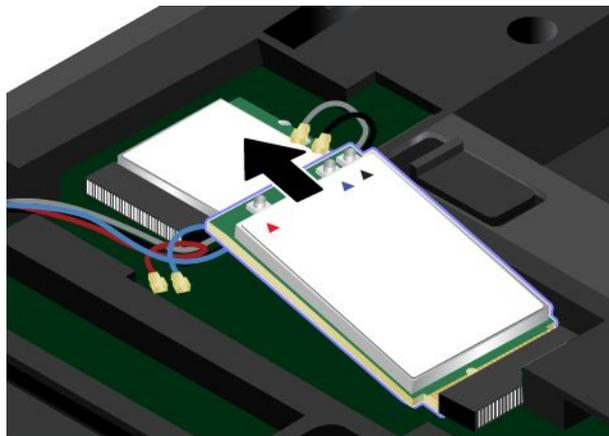
7. Alignez l'encoche de la nouvelle carte réseau étendu sans fil avec le repère situé dans l'emplacement. Insérez ensuite doucement la carte dans son emplacement selon un angle d'environ 20 degrés.
