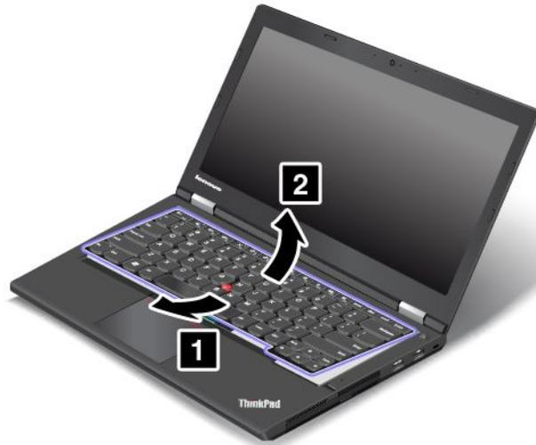
7. Placez le clavier sur le repose-mains et débranchez les connecteurs. Retirez ensuite le clavier.
