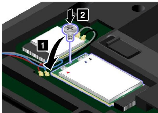
9. Branchez les câbles de l'antenne sur la nouvelle carte réseau étendu sans fil. Branchez le câble rouge sur le connecteur principal sur la carte et le câble bleu sur le connecteur auxiliaire sur la carte.
