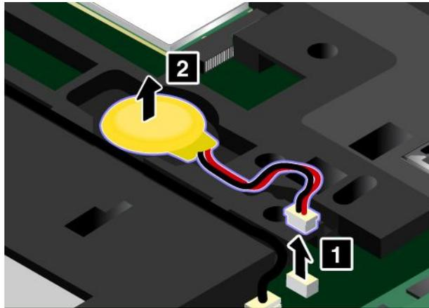
5. Installez la nouvelle batterie à pile cellulaire **1** et branchez le connecteur **2**.
