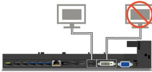
Pour le ThinkPad Ultra Dock, si vous branchez deux écrans sur le connecteur DisplayPort et le connecteur HDMI, le connecteur HDMI est inactif.
