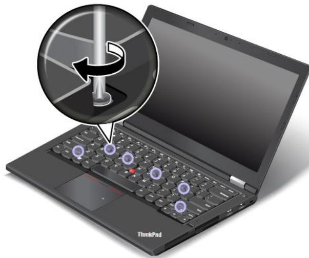
5. Faites glisser le cadre du clavier de 2,5 mm vers l'arrière à l'aide de l'extrémité plate de l'outil spécial clavier de façon à placer les loquets du cadre du clavier sous le panneau du clavier.
