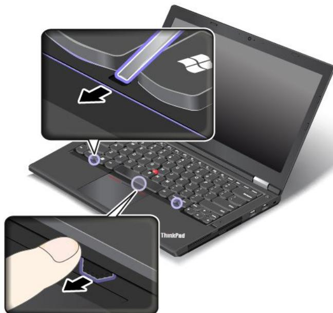
6. Insérez l'extrémité plate de l'outil spécial clavier entre les touches comme illustré, de façon à faire glisser le cadre du clavier vers l'arrière. Assurez-vous qu'il ne reste pas d'espace entre le cadre du clavier et le panneau du clavier.
