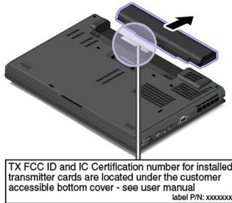
Les étiquettes d'identification FCC et du numéro de certification IC sont apposées sur les cartes réseau local sans fil **1** et réseau étendu sans fil **2** installées dans votre ordinateur.
