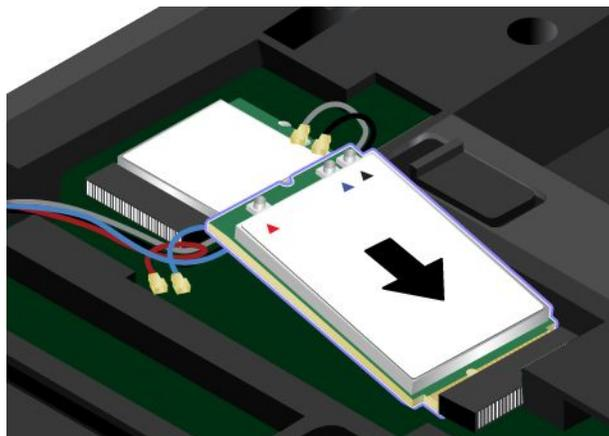
8. Faites pivoter la nouvelle carte réseau étendu sans fil vers le bas **1**, puis installez la vis de fixation de la carte **2**.
