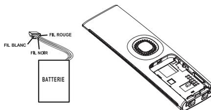
**!** *Utiliser uniquement un pack batterie rechargeable de caractéristiques identiques à celui fourni avec le produit.
