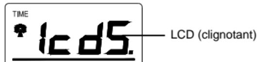
Le contraste de l'écran LCD est réglable sur 8 niveaux, selon les besoins de l'utilisateur (le niveau par défaut est "lcd 5".) Pour régler le contraste au niveau désiré :
