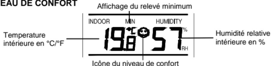
Les température et humidité intérieures sont automatiquement détectées et affichées dans la quatrième section de l'écran LCD.
