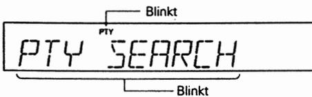
4. Der Suchlauf wird erneut gestartet, wenn die Auf- (UP) oder Ab-Taste (DOWN) gedrückt wird, während die PTY-Anzeige blinkt.
