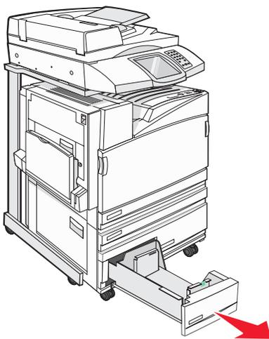
2 Pincez les taquets du guide de largeur vers l'intérieur, de la manière illustrée, puis faites glisser le guide de façon à l'ajuster au format du support chargé.
