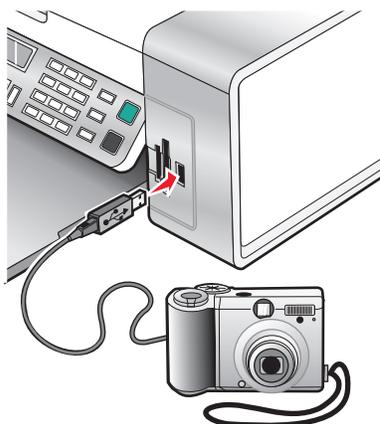
**Attention — Dommages potentiels :** Ne touchez pas le câble USB, les adaptateurs réseau ou la zone de l'imprimante indiquée lorsque des opérations d'impression sont en cours à partir d'un appareil photo compatible PictBridge. Les données risquent d'être perdues. Par ailleurs, n'enlevez pas le câble USB ou l'adaptateur réseau lorsque des opérations d'impression sont en cours à partir d'un appareil photo compatible PictBridge.
