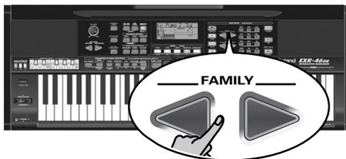
Les paramètres Function de l'EXR-46 OR sont divisés en 9 "familles" selon une répartition logique. Comme le paramètre Bass Inversion est une fonction de l'arrangeur, vous devez choisir les réglages de l'arrangeur (et donc ARR SET).
