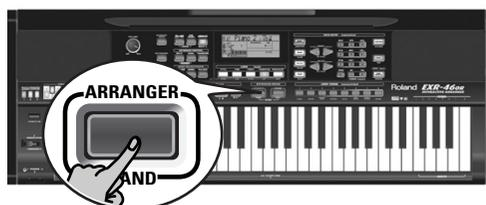
L'icône **ARRANGER** apparaît. Vous pouvez à présent transposer la tonalité de l'arrangeur en temps réel avec votre main gauche.
