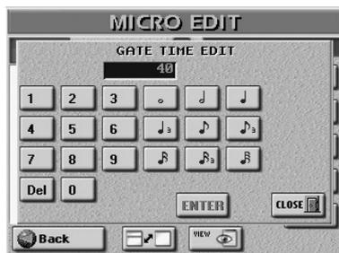
Vous pouvez régler la durée voulue sous forme de valeur CPT (♩ = 120CPT) ou avec des figures de notes pour éviter de longs calculs. La durée maximum d'une note peut être de 65.535 clocks.
