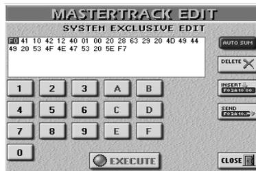
Utilisez les boutons ◀ ▶ pour sélectionner un octet (une paire de chiffres) dans la ligne actuelle et ▲ ▼ pour changer de ligne.
