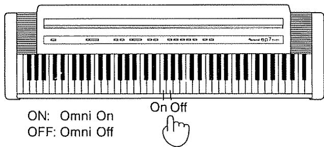
\* Chaque fois que l'instrument est mis sous tension, il est réglé sur "Omni désactivé (OFF)".
