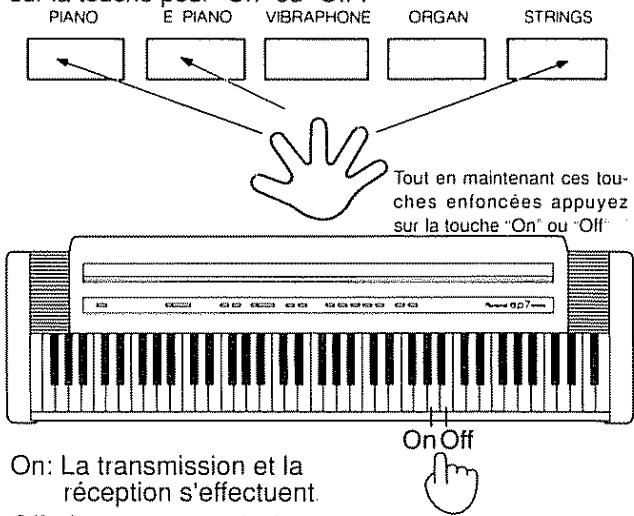
\* Chaque fois que l'appareil est mis sous tension, ce réglage est toujours "On".
