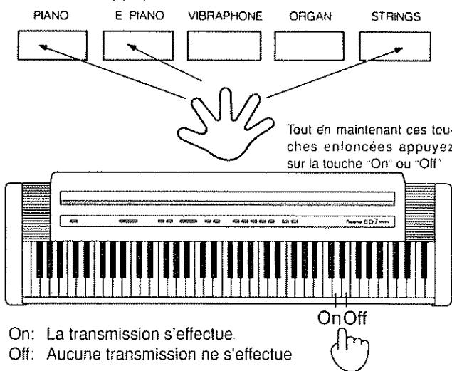
\* Chaque fois que l'appareil est mis sous tension, ce réglage est toujours "Off" (désactivation).
