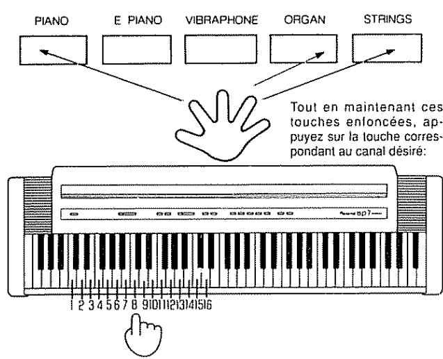
\* Chaque fois que l'instrument est mis sous tension, il réinitialise le canal utilisé pour la transmission et la réception sur le canal "1".
