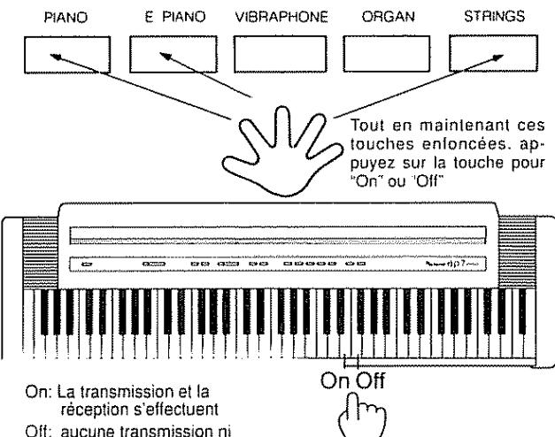
Chaque fois que l'instrument est mis sous tension, il est toujours réglé sur "On" (Activation).
