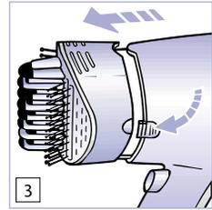
Placez l'accessoire (LISSEUR ou CONCENTRATEUR) sur le corps de l'appareil, en positionnant l'encoche vers le haut (Fig. 1) Enfoncez doucement jusqu'à l'enclenchement de l'accessoire (Fig.2).
