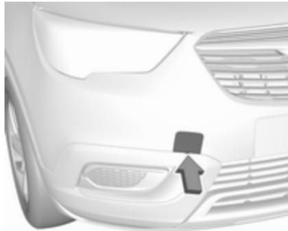
Insérer un tournevis dans la fente du bas du capuchon. Dégager le capuchon en enfonçant avec précaution le tournevis vers le bas.
