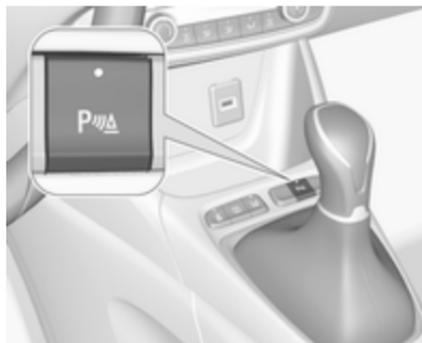
Le système est prêt à fonctionner lorsque la diode du bouton d'aide au stationnement **P**▲ n'est pas allumée. Lorsque le système est désactivé, la diode du bouton s'allume.
