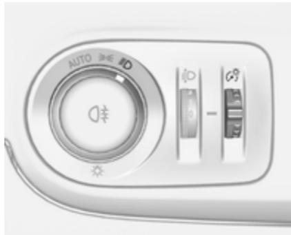
La luminosité des phares suivants peut être réglée en position **AUTO** lorsque le capteur de lumière détecte des conditions de nuit, ou en position  $\Rightarrow$  ou  $\Rightarrow$  :
