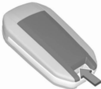
1. Dégrafer le couvercle en utilisant un tournevis dans la rainure.
