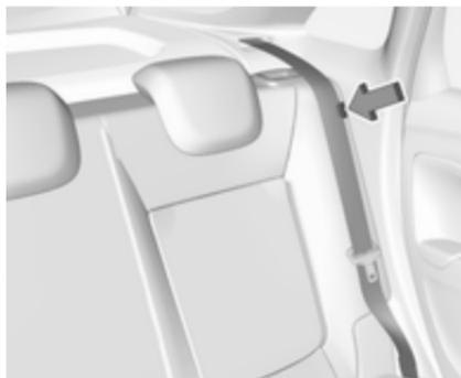
En rabattant les dossiers, insérer les ceintures de sécurité dans les loquets de guidage et tirer les ceintures de sécurité avec eux.
