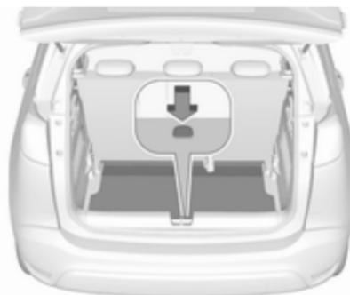
Le recouvrement du plancher arrière peut être retiré. Lever le couvercle à la rainure et le déposer.
