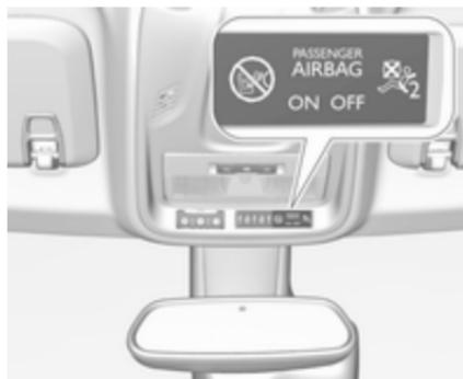
Si le témoin
