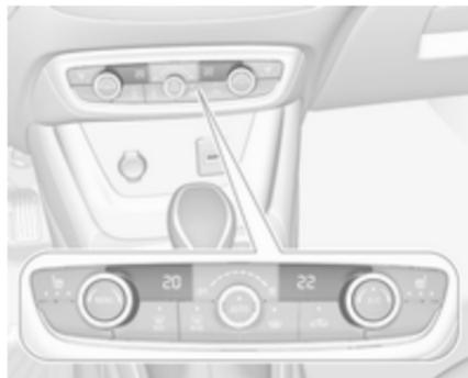
Régler séparément les températures pré-sélectionnées pour le conducteur et le passager avant à la valeur désirée, à l'aide des cadrans de commande gauche et droit. Le cadran du côté passager permet de modifier la température du côté passager. Le cadran du côté conducteur permet de modifier la température du côté conducteur ou des deux côtés selon l'activation de la synchro-
