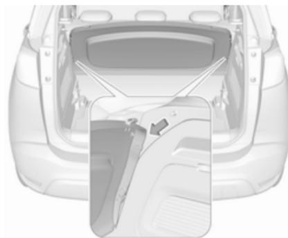
Le couvercle du coffre peut être rangé derrière les dossiers de siège arrière.
