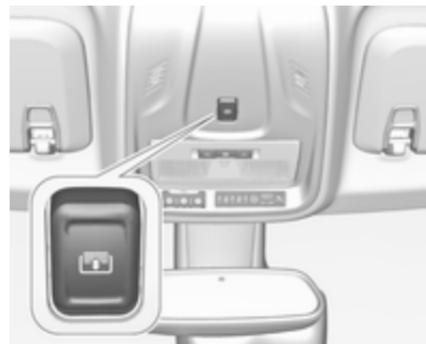
Appuyer doucement sur
