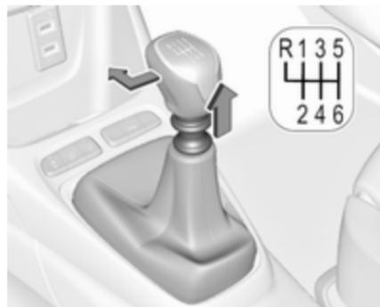
Pour engager la marche arrière d'une boîte de vitesses à 6 rapports, enfoncer la pédale d'embrayage, tirer sur l'anneau sous le levier sélecteur et déplacer le levier sélecteur vers la gauche et l'avant.
