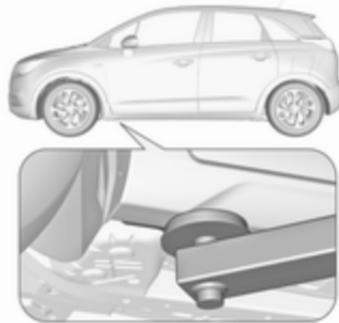
Positionner le bras avant du pont élévateur au niveau du soubassement.
