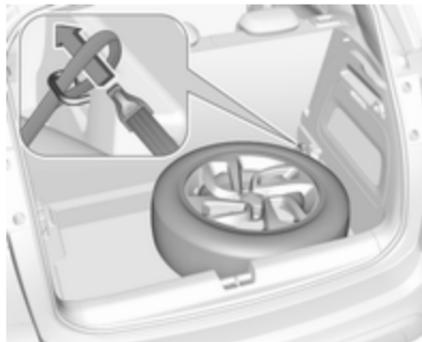
2. Placer l'extrémité libre de la sangle à travers l'anneau d'arrimage avant du côté approprié.
