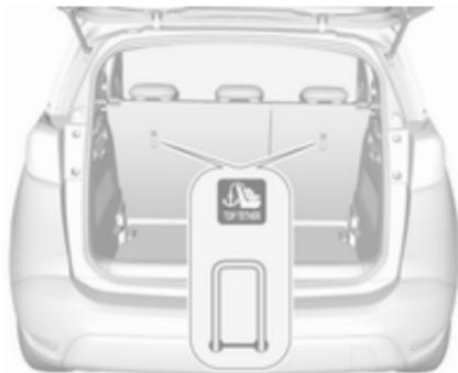
En plus des supports ISOFIX, attacher la sangle Top-Tether aux ancrages Top-Tether.
