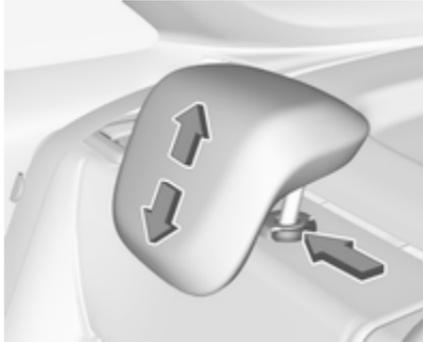
Tirer l'appui-tête vers le haut ou appuyer sur le loquet pour le déverrouiller et abaisser l'appui-tête.
