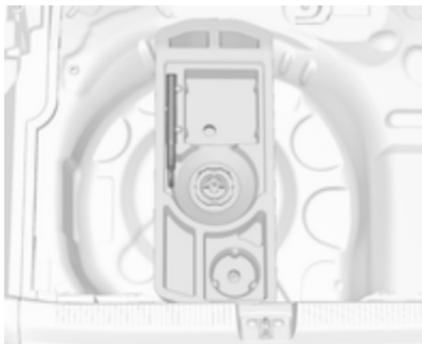
Le tournevis et l'œillet de remorquage se trouvent dans une boîte, sous le couvercle du plancher du coffre.
