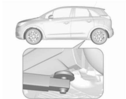
Positionner le bras arrière du pont élévateur au niveau du soubassement.
