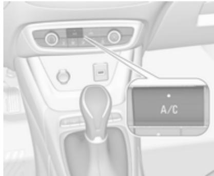
Appuyer sur **A/C** pour mettre le refroidissement en marche. L'activation est signalée par la LED dans le bouton. Le refroidissement ne fonctionne que lorsque le moteur est en marche et que le ventilateur de commande de climatisation est en fonction.
