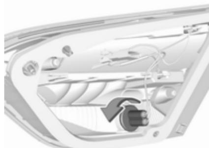
Déposer la douille de l'ampoule de l'ensemble de feu en tournant en sens antihoraire.
