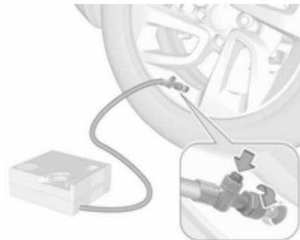
16. Reprendre la route sans délai afin que le produit d'étanchéité se répartisse uniformément dans le pneu. Après un trajet d'environ 5 km (mais pas plus de dix minutes), s'arrêter et contrôler la pression des pneus. À cet effet, visser directement le flexible d'air sur la valve du pneu. Remplir le pneu comme décrit plus haut. Réduire l'excédent de pression de pneu au moyen du bouton du flexible pneumatique.
