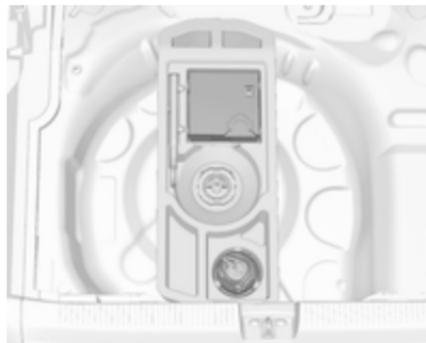
Le kit de réparation des pneus se trouve dans le coffre sous le couvercle de plancher.
