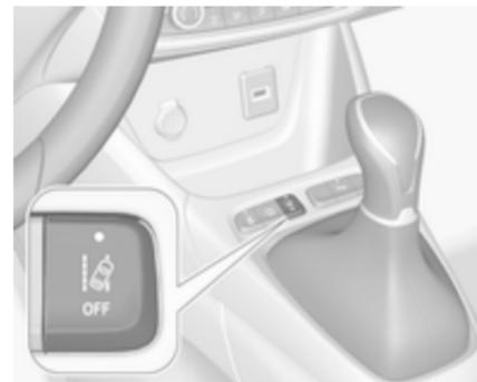
Le système d'avertissement de franchissement de ligne est activé en appuyant sur
