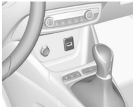
Un ou deux ports USB se trouvent dans la console centrale. Les deux ports USB sont préparés pour des dispositifs de chargement.
