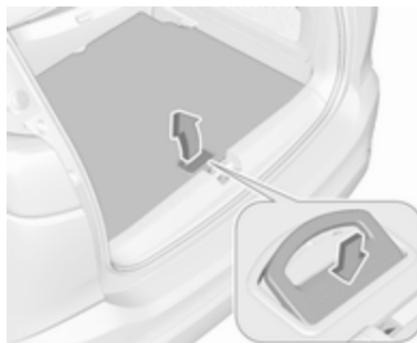
Pour déposer, appuyer sur la poignée pour déverrouiller le plancher de chargement et lever en utilisant la poignée.
