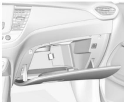
Sur certaines versions, la boîte à gants est ventilée. La ventilation et la température dépendent des réglages du système de commande de climatisation. La bouche d'air de la boîte à gants peut être fermée ⇨ 130.
