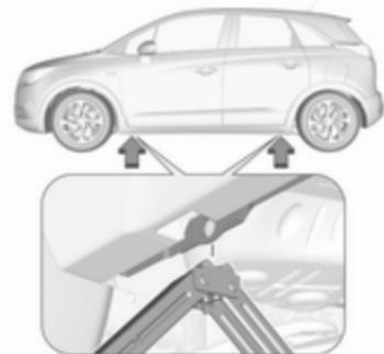
3. Vérifier que le cric est bien positionné sous le point de levage adéquat.
