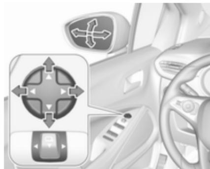
Sélectionner le rétroviseur extérieur concerné en appuyant sur le bouton de rétroviseur vers la gauche ou la droite.
