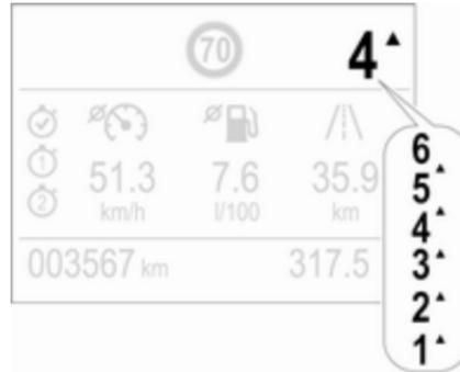
Lorsqu'il est recommandé de passer au rapport de vitesse supérieure pour permettre d'effectuer des économies de carburant, ▲ est affiché avec le chiffre d'un rapport supérieur.
