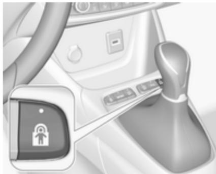
Système commandé à distance pour éviter l'ouverture des portes arrière au moyen des commandes intérieures et l'utilisation des lève-vitres électriques arrière.
