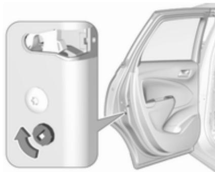
Pour verrouiller les autres portes, commencer par déposer le couvercle noir en insérant une clé et en tournant dans le sens horaire.
