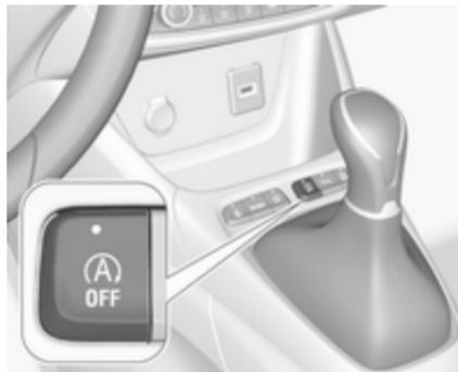
Pour désactiver le système Stop/Start manuellement, appuyer sur
