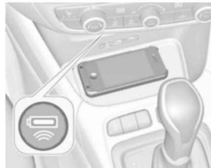
Pour charger un périphérique, le contact doit être mis.
