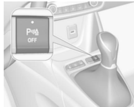
Le système est désactivé lorsque la marche arrière est désengagée. Appuyer sur **P**
