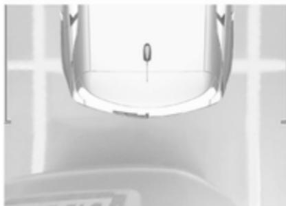
La caméra enregistre les environs du véhicule pendant la manœuvre pour reconstruire une vue depuis le haut de l'arrière du véhicule dans son envi-
