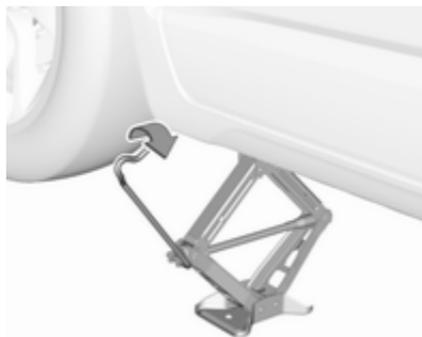
Attacher la clé de roue, aligner correctement le cric et tourner la
