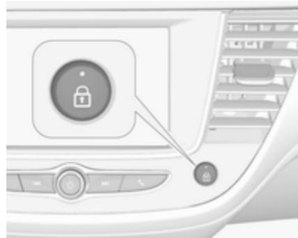
Vous pouvez activer ou désactiver cette fonction de manière permanente. Contact mis, appuyer sur
