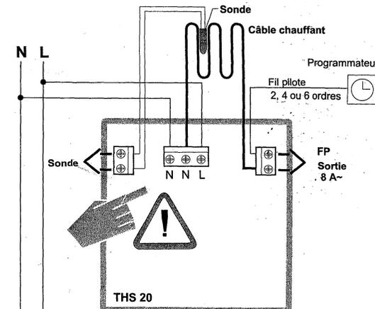
La sonde doit être installée dans un tuyau de PVC entre deux câbles chauffants dans le sol.
