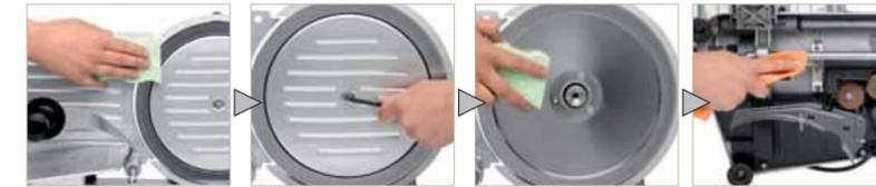
Wipe down using a sponge and hot soapy water. Mit einem Schwamm und warmem Wasser reinigen.
