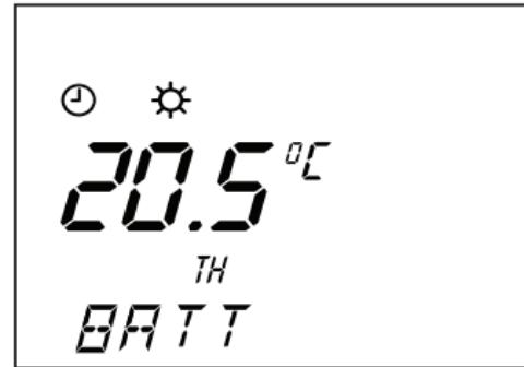
Lorsque "BATT" apparaît sur l'afficheur, la durée de vie des piles est équivalente à un mois environ.
