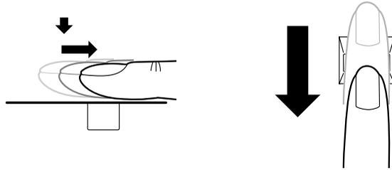
Alignez le doigt sur le capteur comme indiqué dans l'illustration suivante.
