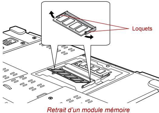
8. Remplacez le couvercle du module mémoire et fixez-le à l'aide d'une vis.
