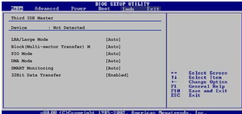
Les valeurs sises aux éléments grisés (Device, Vendor, Size, LBA Mode, Block Mode, PIO Mode, Async DMA, Ultra DMA, et SMART monitoring) sont auto-détectées par le BIOS et ne sont pas configurables. Ces éléments apparaissent N/A si aucun périphérique IDE n'est installé sur le système.
