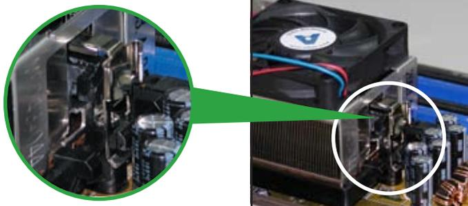
3. Aligned l'autre crochet de rétention (situé à côté du système de verrouillage) à la base du module de rétention. Un léger cliquetis vous informe que le crochet est bien en place.
