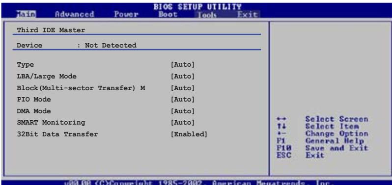
Le BIOS détecte automatiquement les valeurs des éléments grisés (Device, Vendor, Size, LBA Mode, Block Mode, PIO Mode, Async DMA, Ultra DMA, et SMART monitoring). Ces valeurs ne sont pas configurables par l'utilisateur. Ces éléments affichent N/A si aucun périphérique IDE n'est installé dans le système.
