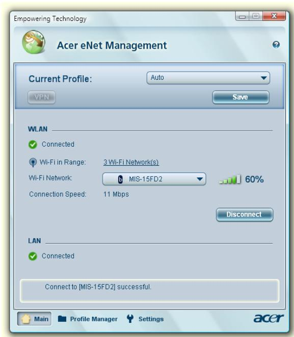
Acer eNet Management peut enregistrer vos paramètres réseau pour un lieu dans un profil et appliquer automatiquement le profil approprié lorsque vous allez d'un lieu à un autre. Les paramètres enregistrés comprennent les paramètres de connexion au réseau (paramètres IP et DNS, les détails AP sans fil, etc.) ainsi que les paramètres d'imprimante par défaut. Pour des raisons de sécurité, Acer eNet Management ne stocke pas les informations de nom d'utilisateur et de mot de passe.
