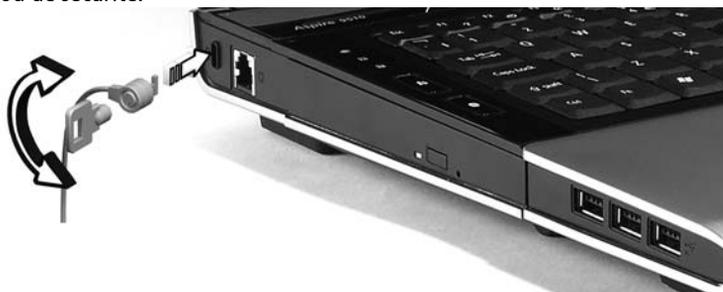
Enroulez le câble du cadenas de sécurité pour ordinateur autour d'une table, de la poignée d'un tiroir verrouillé, ou de tout autre objet fixe. Insérez le cadenas dans l'encoche et tournez la clef pour verrouiller le cadenas. Certains modèles ne possèdent pas de clef.
