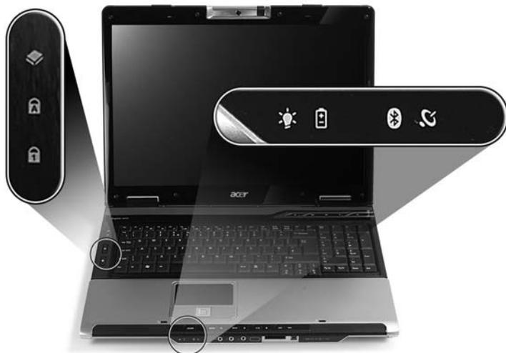
Les indicateurs d'état de l'alimentation, de la batterie et de la communication sans fil sont visibles même lorsque l'écran LCD est fermé.
