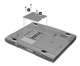
3 Insérez le module mémoire en diagonale dans le connecteur (a), puis appuyez doucement sur le module (b) jusqu'à ce qu'il se mette en place avec un déclic.
