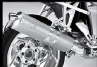
Le silencieux sport mis au point conjointement avec Laser est réalisé en titane et en acier inoxydable. Il pèse environ 4 kg de moins que le silencieux de série et se caractérise par une sonorité rageuse et une esthétique d'enfer.
