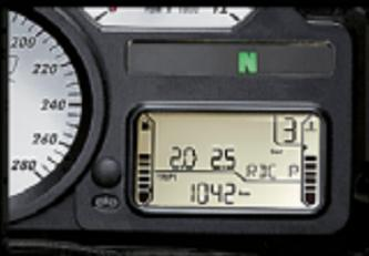
Le système de contrôle de la pression des pneumatiques RDC surveille en permanence la pression dans les pneus grâce à des capteurs et prévient le pilote de tout écart de pression anormal sur l'affichage de l'ordinateur de bord ou par un témoin.
