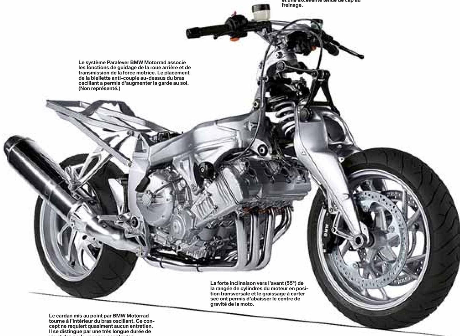
La forte inclinaison vers l'avant (55°) de la rangée de cylindres du moteur en position transversale et le graissage à carter sec ont permis d'abaisser le centre de gravité de la moto.
