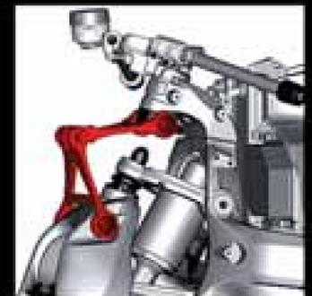
Le mécanisme intelligent est à l'origine de réserves importantes au niveau du ressort et d'une compensation optimale de la plongée au freinage. Le guidage de roue et la suspension sont dissociés, ce qui réduit la tendance au cabrage et améliore la sensibilité de la direction.
