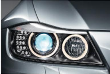
□ **Projecteurs bi-Xénon, avec lave-projecteurs** et clignotants à DEL. Inclut quatre anneaux lumineux pour fonction d'éclairage diurne et réglage automatique de la portée des projecteurs.
