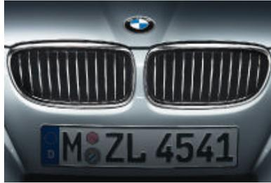
■ **Calandre** avec contour spécial et barres longitudinales chromées. Les barres restent noires sur les modèles 4 cylindres.
