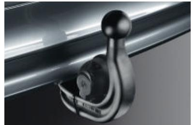
□ **Crochet d'attelage** (escamotable mécaniquement) avec contrôle de stabilité de l'attelage et déverrouillage électrique via un interrupteur dans le coffre à bagages.
