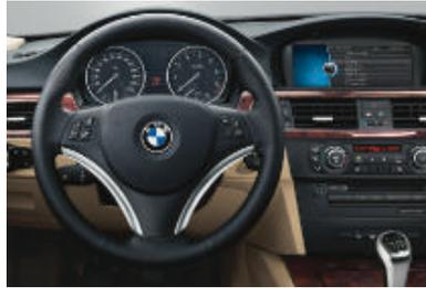
□ **Volant Sport gainé cuir** (diamètre 369 mm), trois branches, pommeau du levier de vitesses et volant avec insert chromé, et poignée du frein à main en cuir. Les touches multifonctions permettent de commander l'autoradio ou le téléphone (option).
