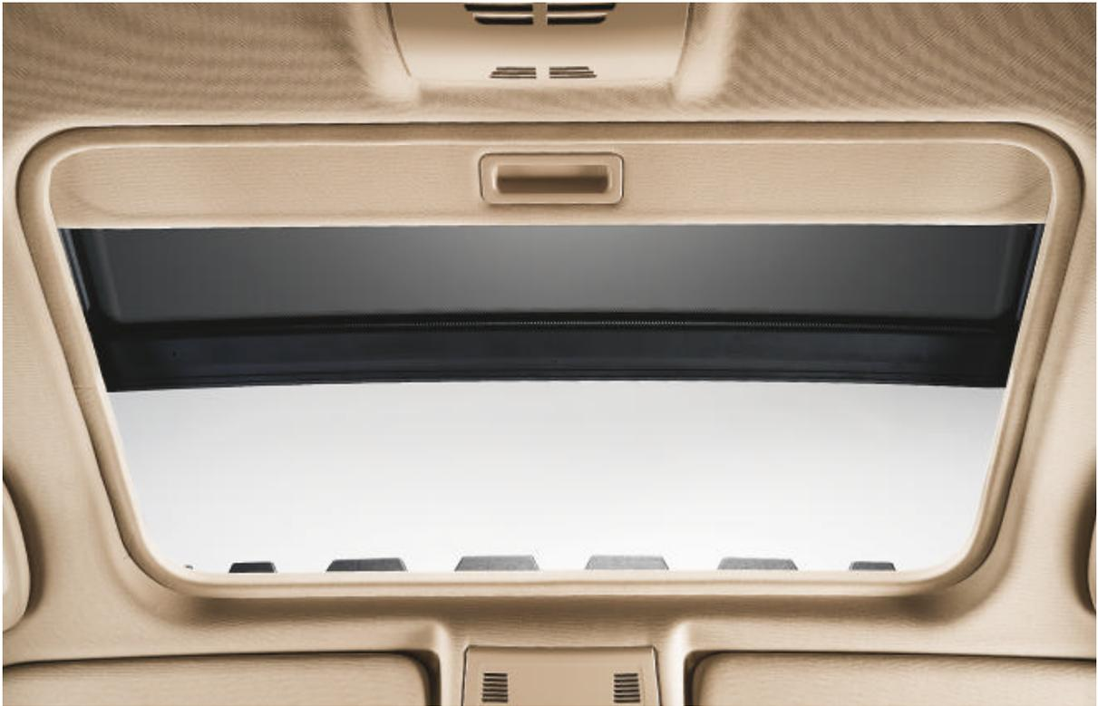
□ **Toit ouvrant en verre coulissant et entrebâillable électriquement**, avec déflecteur et ouverture confort par la télécommande.
