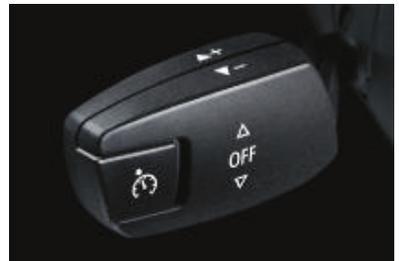
■ **Régulateur de vitesse**. À partir de 30 km/h environ, il mémorise et maintient la vitesse souhaitée (affichée au tableau de bord). Après une accélération, le régulateur rétablit automatiquement la vitesse enregistrée au préalable. Lorsque le conducteur freine, la fonction est désactivée. Les modèles 6 cylindres disposent en plus d'une fonction freinage.
