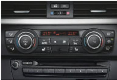
□ **Climatisation automatique bi-zone**, avec recyclage automatique AUC, filtre microporeux et touche All. Avec réglage individuel de la température à l'avant (à gauche et à droite), espace de rangement climatisé dans la console centrale, et climatisation et ventilation des places arrière dans la console centrale. De série sur tous les modèles 330 et 335.
