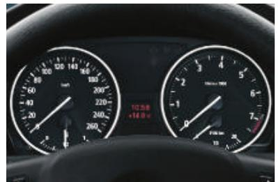
■ **Tableau de bord** avec instruments analogiques et éclairage par transparence. Indicateur de vitesse avec jauge de carburant, compte-tours avec affichage de la consommation (de la température de l'huile sur BMW 335i), affichage LCD pour totalisateur de distance et totalisateur journalier, indicateur de température extérieure et montre.
