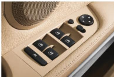
■ **Lève-vitres électriques à l'avant et à l'arrière**, avec commande par impulsion, ouverture/fermeture confort et protection anti-pincement à toutes les vitres.
