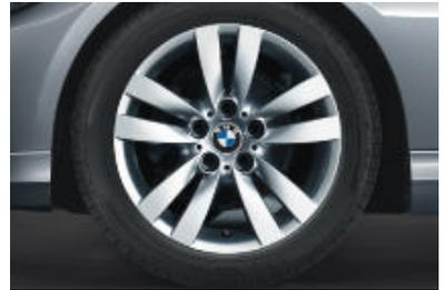
□ **Jantes en alliage léger 17" style 161 à rayons doubles**, 8 J x 17 pouces, pneumatiques RSC permettant le roulage à plat 225/45 R 17.
