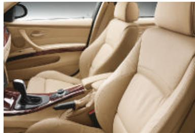
□ **Sièges avant Sport** avec appuis-tête actifs (représentés ici recouverts de cuir optionnel Dakota « Beige »). Ils offrent un maintien latéral optimal grâce aux réglages électriques en continu de la largeur du dossier ; réglages manuels de la hauteur d'assise, de l'inclinaison du siège et du dossier, et de la profondeur de l'assise.
