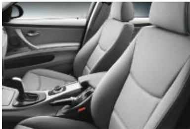
■ **Sièges de série**, avec réglages manuels, y compris réglage de la hauteur d'assise pour les sièges conducteur et passager avant et appuis-tête actifs.
