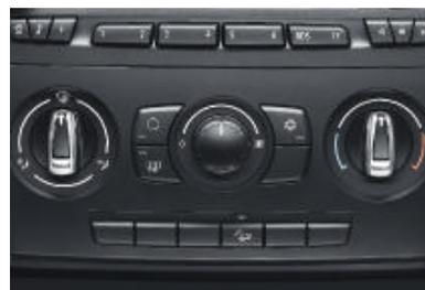
■ **Climatisation**, avec filtre microporeux et touche de recyclage de l'air pour maintenir une température agréable dans l'habitacle quelle que soit la saison. Avec réglage manuel du débit et de la répartition de l'air.
