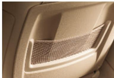
□ **Kit rangement** avec filets à bagages au dos des sièges avant, deux porte-boissons escamotables à l'avant, deux porte-boissons dans l'accoudoir central à l'arrière et vide-poches côté conducteur et à l'arrière. Cet équipement comprend également deux prises 12 V à l'arrière et deux œilletons d'arrimage supplémentaires dans le coffre à bagages.
