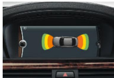
□ **Système d'aide au stationnement PDC<sup>2</sup>** avant et arrière ou uniquement arrière : il facilite les manœuvres de stationnement dans un espace réduit. Le PDC indique que votre véhicule s'approche d'un obstacle par un signal acoustique (ou optique sur l'écran en combinaison avec un système de navigation).
