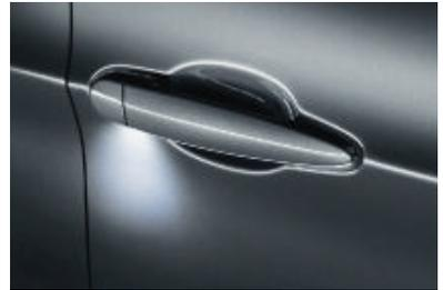
□ **Le kit éclairage** comprend des liseuses à l'avant et à l'arrière, l'éclairage des miroirs de courtoisie et du bas de l'habitacle à l'avant, un éclairage d'ambiance à l'arrière, des spots de descente de voiture et des poignées de portes extérieures avec éclairage intégré. Lorsque vous déverrouillez les portes, la zone d'accès au véhicule ou de descente est éclairée de manière homogène pour plus de confort et de sécurité.
