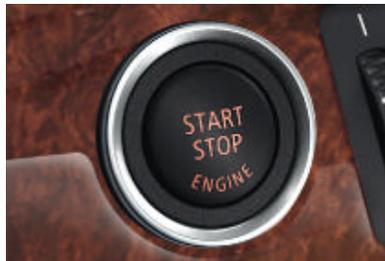
■ **Bouton de démarrage « Start/Stop »**. Il permet de démarrer la voiture par le biais de la clé à télécommande, après avoir inséré cette dernière. Appuyer sur le bouton « Start/Stop » permet de démarrer ou d'arrêter le moteur.
