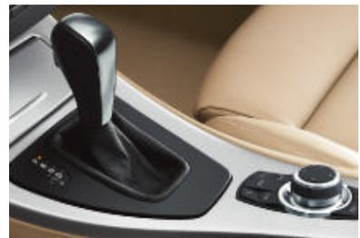
□ **Boîte de vitesses automatique à 6 rapports** avec Steptronic et commande autoadaptative de la boîte de vitesses AGS. Elle permet des passages de vitesses rapides et confortables et garantit une dynamique de conduite optimale (de série sur BMW 335d, non disponible sur BMW 316i/d).
