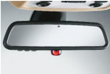
□ **Rétroviseur intérieur électrochromique** avec miroir de grande dimension et liseuses à l'avant. Représenté ici avec l'option Télécommande universelle intégrée.
