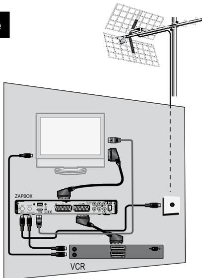
Lancez alors l'enregistrement sur la chaîne AV du magnétoscope (0, AV, EXT,...)
