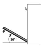
3. Pour remonter la porte, introduisez les charnières dans les fentes prévues à cet effet sur le four en vous assurant que les rainures **A** sont complètement posées contre les fentes. Abaissez la porte puis, après l'avoir positionnée, sortez les pivots des trous des charnières.
