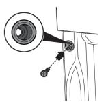
Couvrez les douilles avec les bouchons démontés précédemment.
