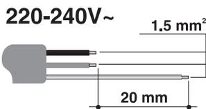
L'extrémité du fil de mise à la terre (jaune-vert) à brancher sur l'appareil devra dépasser d'au moins 20 mm.
