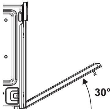
Pour remonter la porte, introduisez les charnières dans les fentes prévues à cet effet sur le four en s'assurant que les rainures **C** sont complètement posées contre les fentes. Abaissez la porte puis décrochez les leviers **A**.
