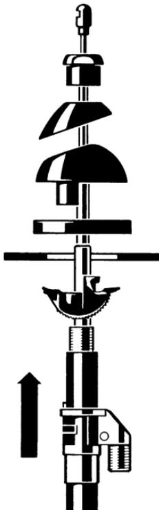
Bohrungsunterseite blank machen und mit säurefreiem Fett schützen.
