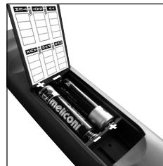
**Wij raden aan geen lege batterijen in de afstandsbediening te laten zitten; ze kunnen vloeistof lekken en de afstandsbediening beschadigen**
