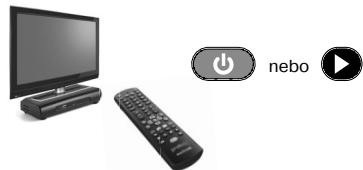
**4.** Když přístroj reaguje správným způsobem, stiskněte tlačítko **OK**. Tři dlouhá bliknutí označují, že operace proběhla **správně**.
