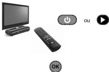
4. Quando o aparelho responder correctamente, pressionar a tecla **OK**. Três lampejos longos indicam que a operação se concluiu em modo **regular**.
