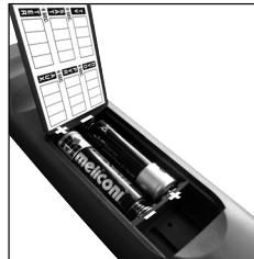
**Raccomandiamo di non lasciare inserite batterie esaurite, potrebbero rilasciare liquido e danneggiare il telecomando**
