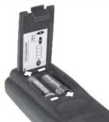
Soulevez la trappe située à l'arrière de la télécommande. Insérez 2 piles 1,5 V neuves de type R06/AA/UM-3.
