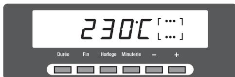
Choisir un mode de cuisson et ajuster si nécessaire la température. Ex. ci-contre cuisson en convection naturelle à 230°C. La validation est automatique après 3 secondes.
