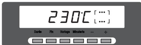
Choisir un mode de cuisson et ajuster si nécessaire la température. *Ex. ci-contre: cuisson en convection naturelle à 230°C. La validation est automatique après trois secondes.*
