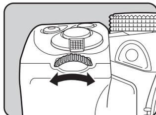
En mode **M**, la différence avec l'exposition correcte s'affiche sur une échelle graduée pendant le réglage de la vitesse d'obturation ou de la valeur d'ouverture. La valeur d'exposition clignote en rouge lorsque la différence avec l'exposition correcte est  $\pm 3,0$  ou plus.
