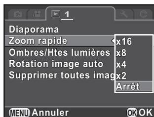
**3** Utilisez le bouton de navigation (▲▼) pour sélectionner [Ombres/Htes lumières] ou [Rotation image auto], et utilisez le bouton de navigation (◀▶) pour sélectionner  ou .
