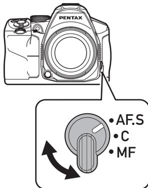
Les modes de mise au point automatique pour une prise de vue avec le viseur sont différents de ceux utilisés pour une prise de vue avec Live View.
