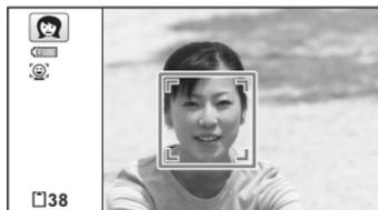
Si l'appareil détecte un visage en mode
