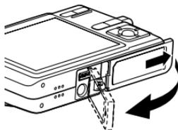
2. Tout en orientant la face arrière de la carte dans la même direction que l'écran de l'appareil photo, insérez-la carte avec précaution dans le logement de carte. Poussez-la à fond dans le logement jusqu'à ce qu'elle s'encliquette.
