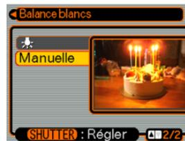
4. Dirigez l'appareil vers du papier blanc ou un objet similaire sous l'éclairage qui sera utilisé, puis appuyez sur le déclencheur.
